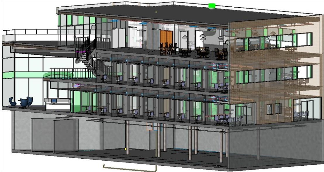
Kuva 3. Kolmikerroksisen toimistorakennuksen 3D-leikkausnäkö Revitissä.
