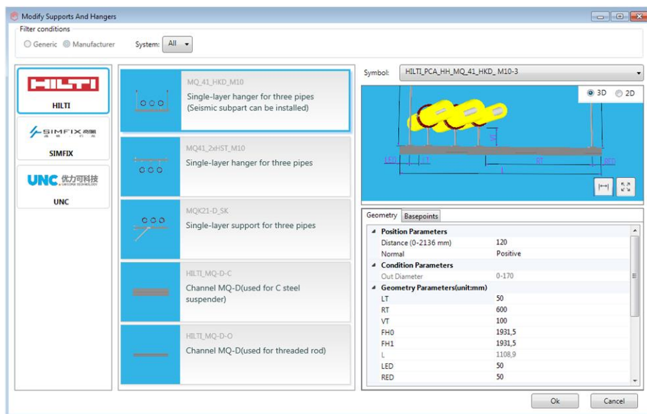
Kuva 15. MagiCAD Supports & Hangers -sovelluksen kannakkeenvalintanäkymä, jossa voidaan valita haluttu kannaketyyppi sekä muokata kannakkeen eri osien mittoja.
