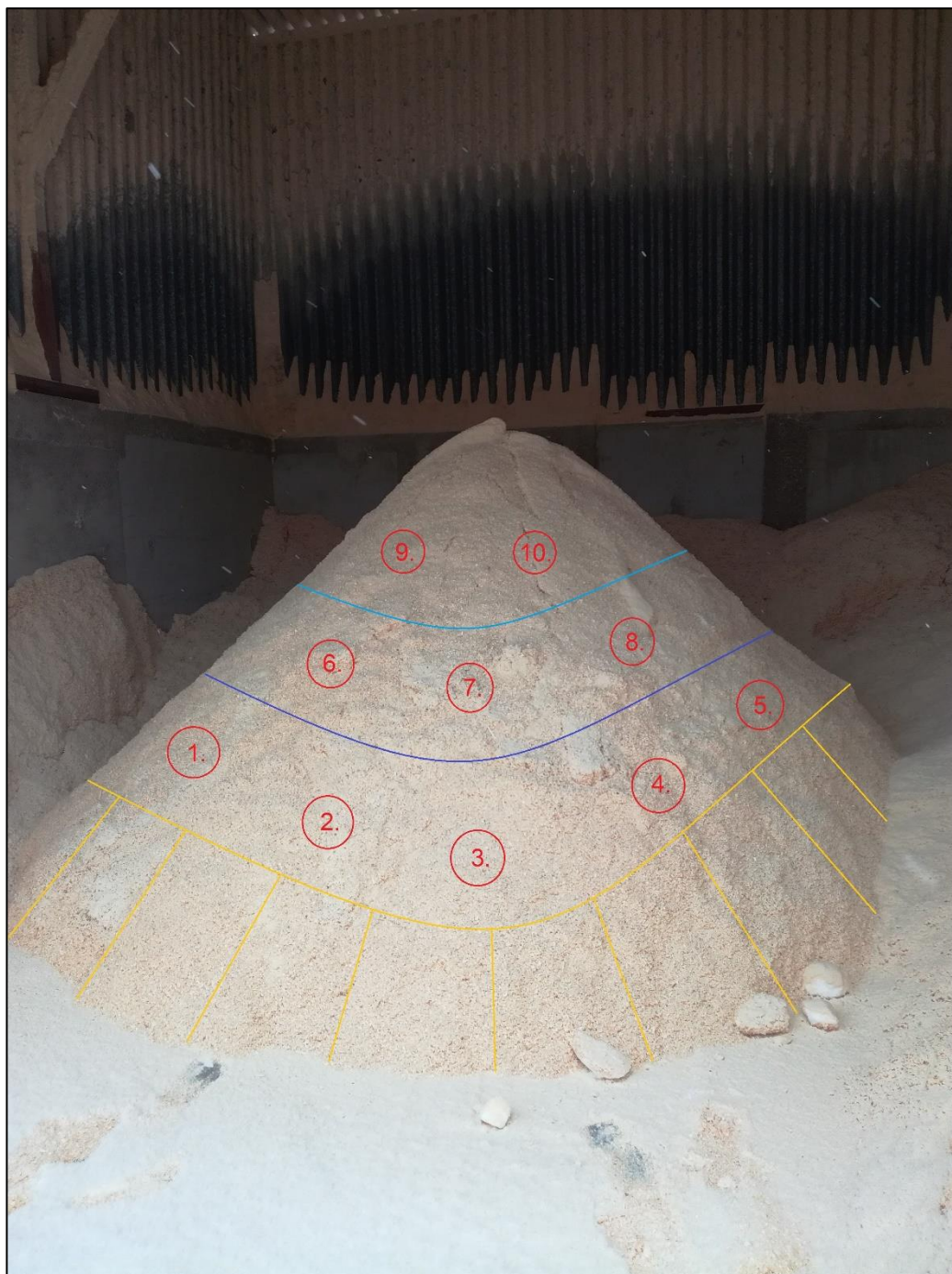
Kuva 30. Näytteenottopisteet välivaraston kutterinlastukasasta (Kuva: Toni Kortelainen 2017).
