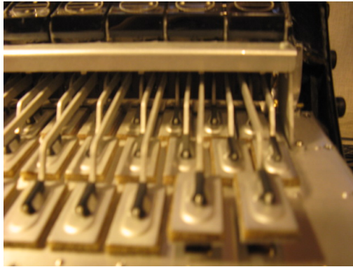
Kuvio 9. Koskettimen varren päässä olevia läppiä. Läpän alla näkyy ilmakanavan reikä.
