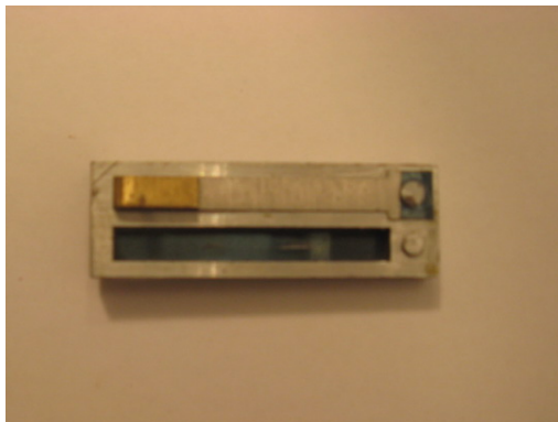
Kuvio 3. Yksittäinen kielilaatta niitatuilla teräslehdyköillä ilman kieliventtiiliä.
