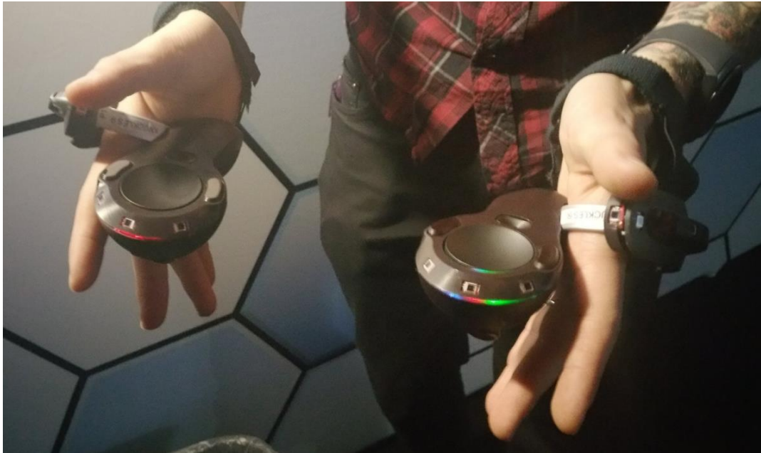
Kuvio 13. Prototyypin käsiohjaimet pysyvät kiinni ranteissa.
