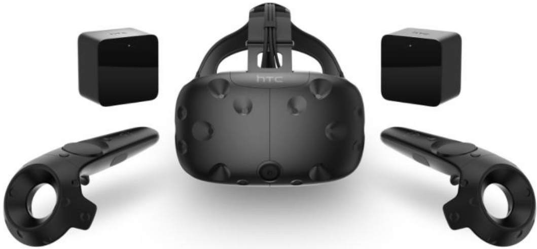
Kuvio 12. HTC Vive laitteen osat. Laseissa näkyvät syvennykset ovat sensoripisteitä.
