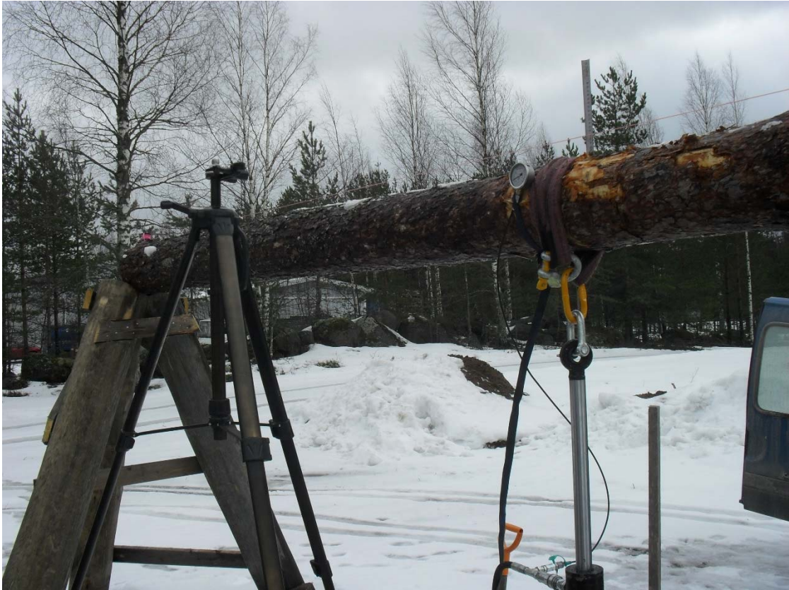
Kuva 6, painemittarin, linjalangan ja kameran asettelu (Gardemeister 2017)
