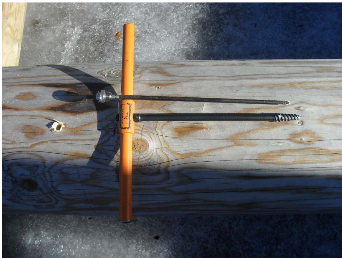
Kuva 9, kasvukaira ja näytteen porausreikä (Gardemeister 2017)
