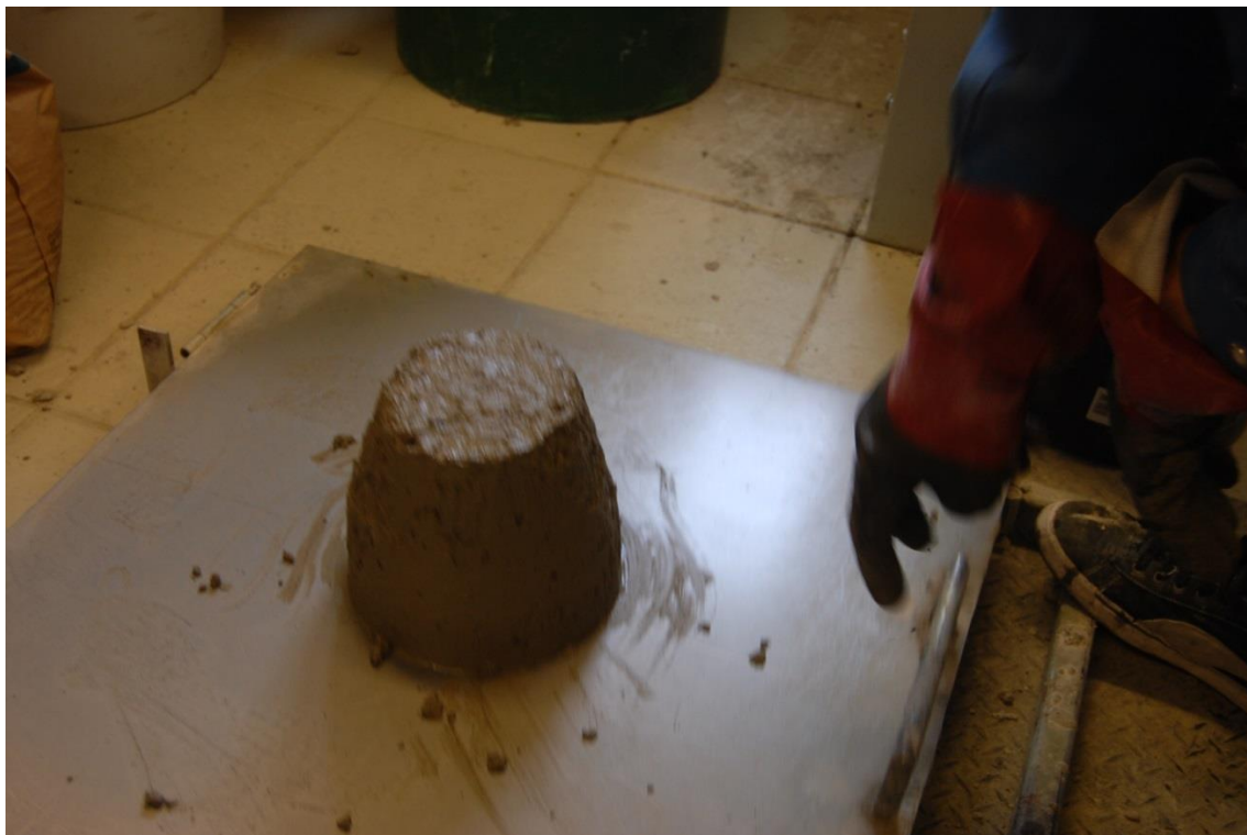
Kuva 4. Betonikakku leviämäpöydällä (Laitinen 2016-05-15)
