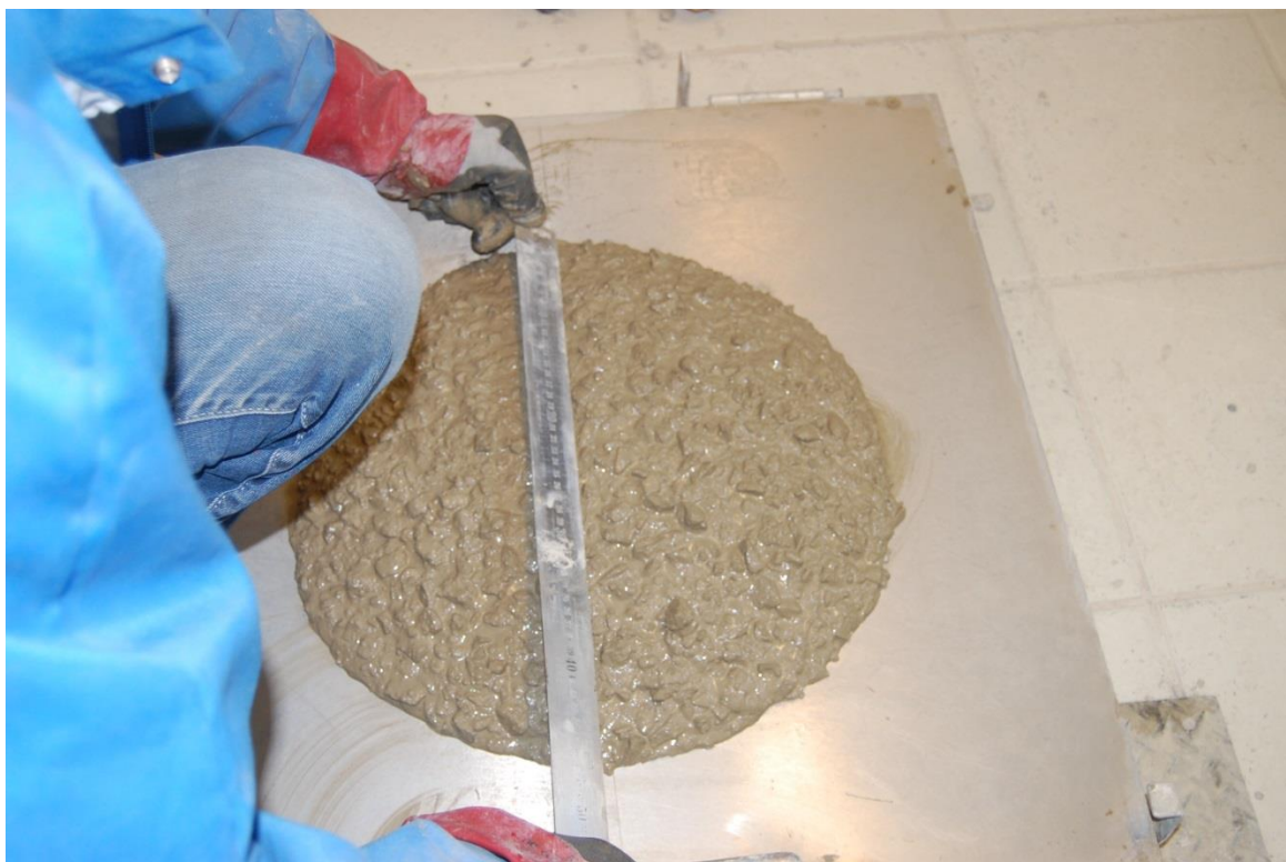
Kuva 6. Leviämän mittaus (Laitinen 2016-05-15)
