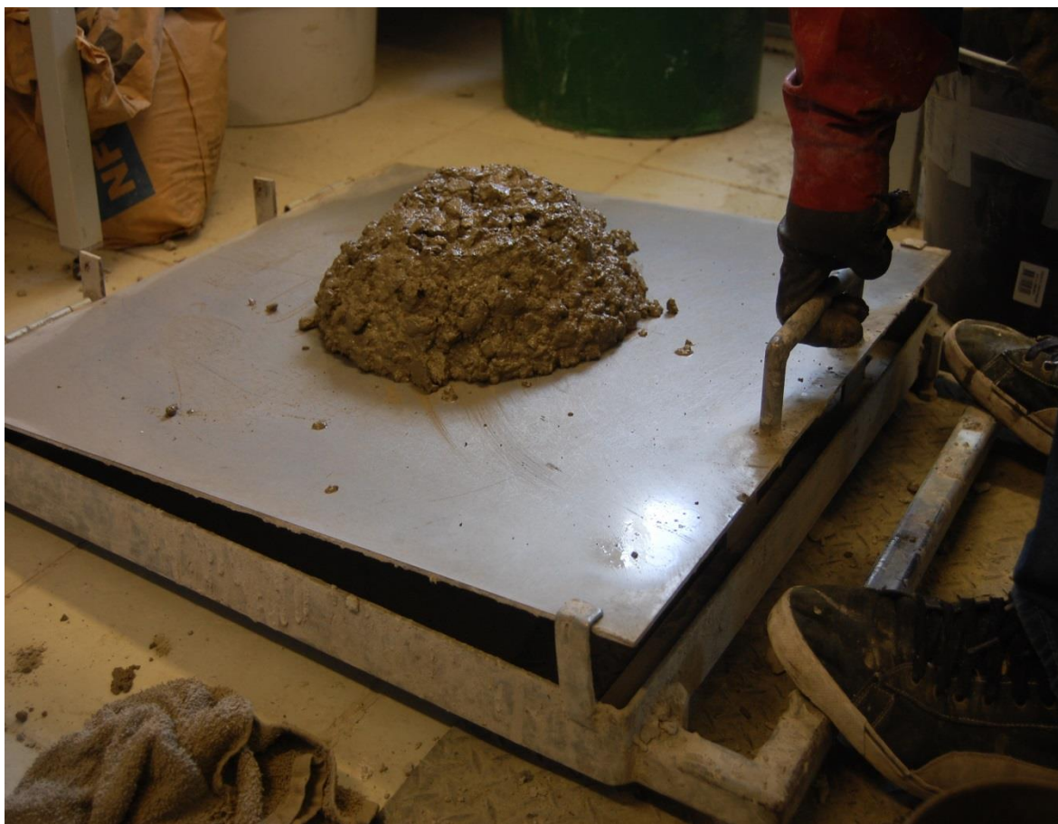
Kuva 5. Leviämän aikaansaaminen (Laitinen 2016-05-15)
