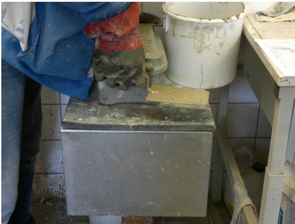
Kuva 8. Ylimääräisen ilman poistaminen tärytyspöydällä (Laitinen 2016-05-15)
