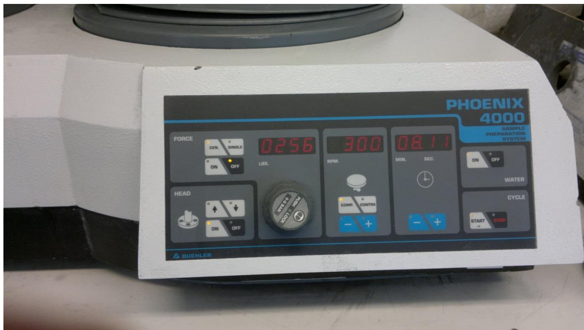
Kuva 12. Näyteviipaleen hiontalaitteen säätöpaneeli (Laitinen 2016-05-15)
