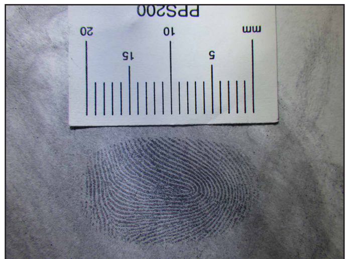
Paperilta magneettijauheella esillehaettu sormenjälki. Kuvattu kompaktikameralla. Kuva valaistu objektiivin vierestä pehmenneellä taskulampun valolla. Muista, että sormenjälkikuvissa on erityisen tärkeää, että mitan numerot tai kirjaimet ovat näkyvissä.
