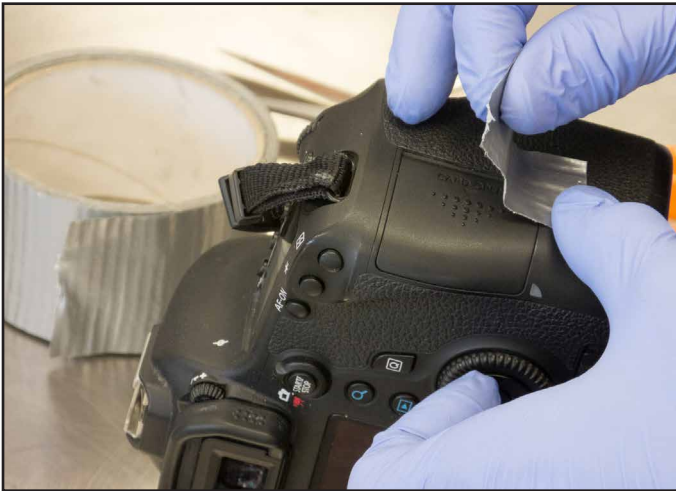
Kameran liitosten suojaaminen ilmastointiteipillä.
