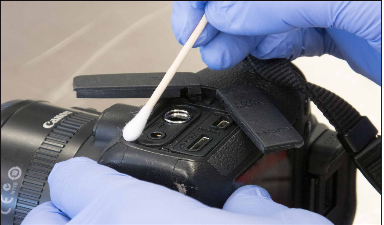
Pumpulipuikolla tiivisteiden puhdistaminen.
