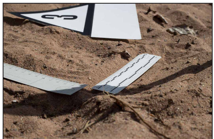
Mitta tulee olla jäljen pohjan kanssa samalla tasolla.
