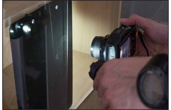
45 asteen sivuvalo. Kuvan sormenjälkeä ei ole vielä haettu esille. Huomaa, että kuvassa valo menee hieman jäljen vastakkaiselta suunnalta ohi.
