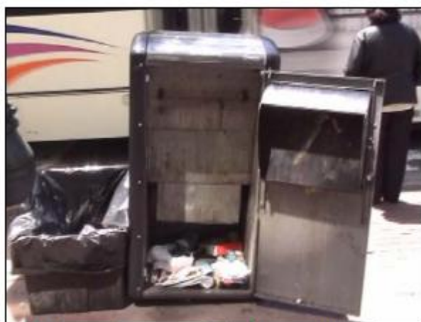
Kuva 10. Jätepuristin on jäänyt ala-asentoon ja jäteastian ovi on jätetty auki (Philadelphia City Controllerin raportti 5.7.2010)
