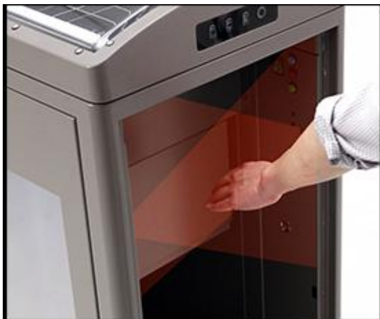
Kuva 11. Clean Cube -jätessäiliön liikeseisori katkaisee toiminnan mikäli säiliöön ollaan lisäämässä jätettä (Ecube Labs 2011-2017)
