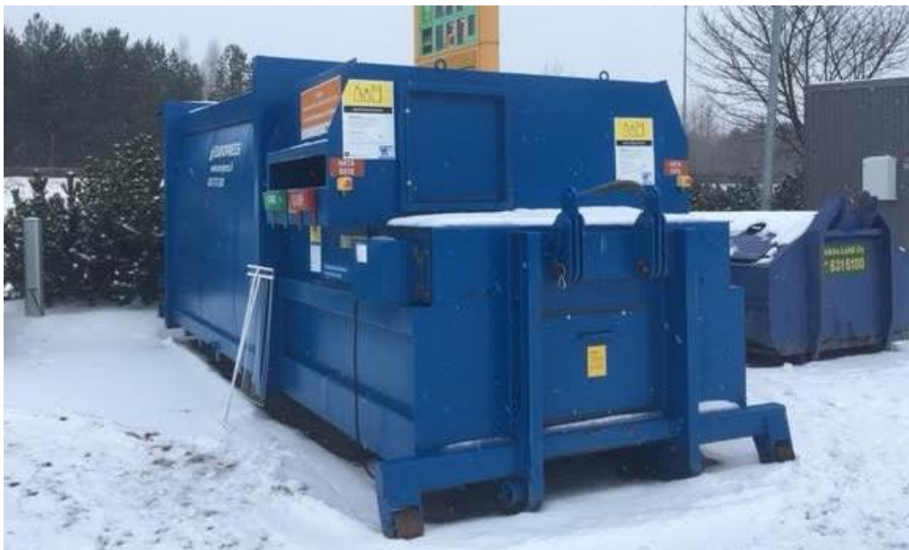
Kuva 22. Tikkulan kierrätyspisteen jätepuristin (kuvannut Tanja Pirttimäki).
