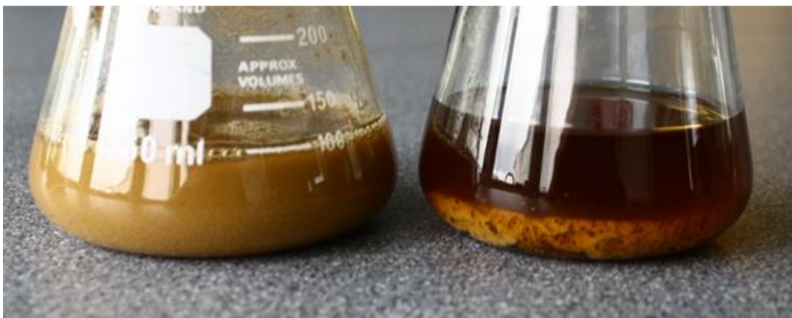
Kuva 12. Autoklavoidut kasvatusliuokset fermentointipulloissa. Autoklavoinnin jälkeen kaikki liuokset näyttivät samalta kuin oikeassa pullossa oleva. Vasenta pulloa ravisteltiin, jotta sakka olisi liennut takaisin, mutta komponentit eivät lienneet enää täydellisesti.
