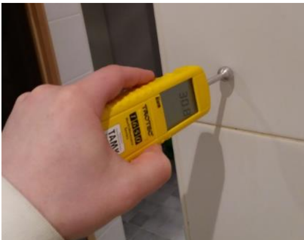
Kuva 45. Trotec T650 pintakosteusmittari.
