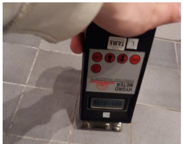
Kuva 46. Doser BS-2 pintakosteusmittari.
