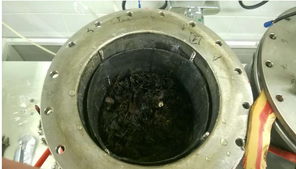
Kuva 41. Reaktorin sisään asennettu verkko täytettynä syötteellä.
