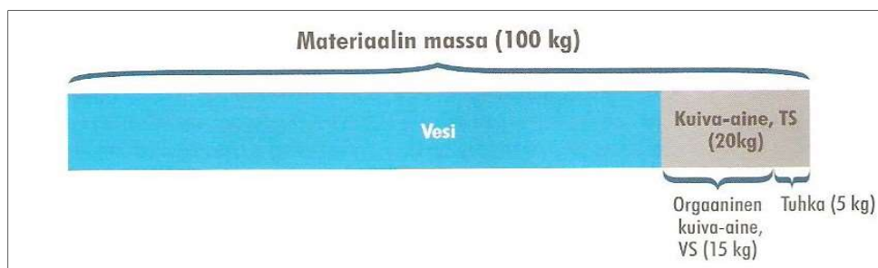
Kuva 25. Esimerkkinä näytteen kokonaismassa sekä TS-,VS- ja tuhkamääritelmät. Esimerkissä näytteen vesipitoisuus on 80 %, TS 20 %, VS 15 % ja tuhka 5 %. (Kymäläinen 2015b, 23.)
