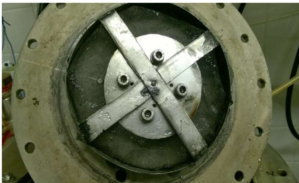
Kuva 42. Reaktorin kanteen asennettu sirotin.
