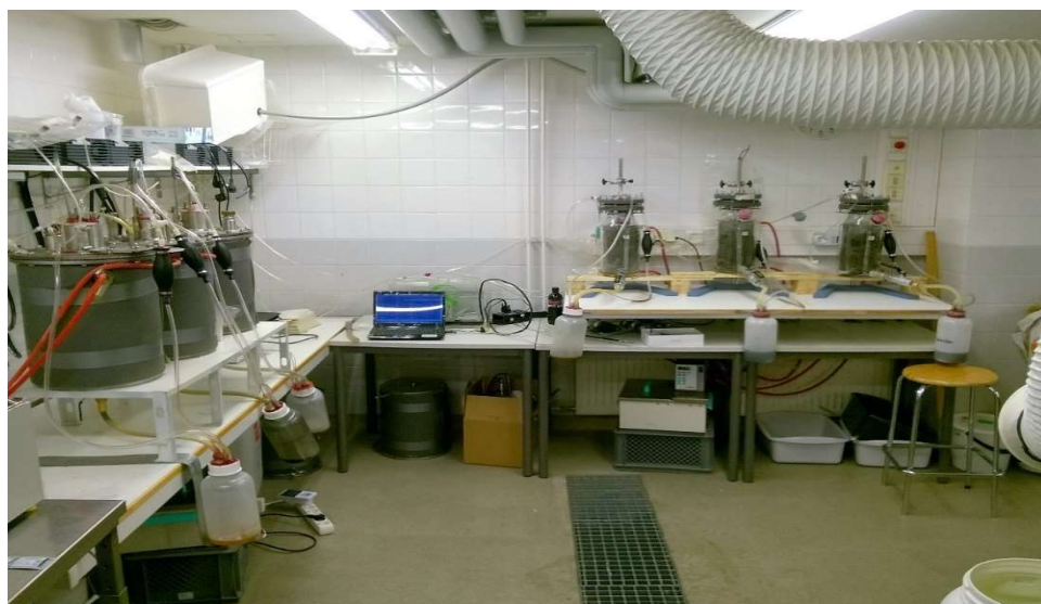
Kuva 40. Koejärjestelyn kuusi reaktoria. Kuvassa vasemmalla suuremmat 12l kooreaktorit ja oikealla pienemmät 4l kooreaktorit.
