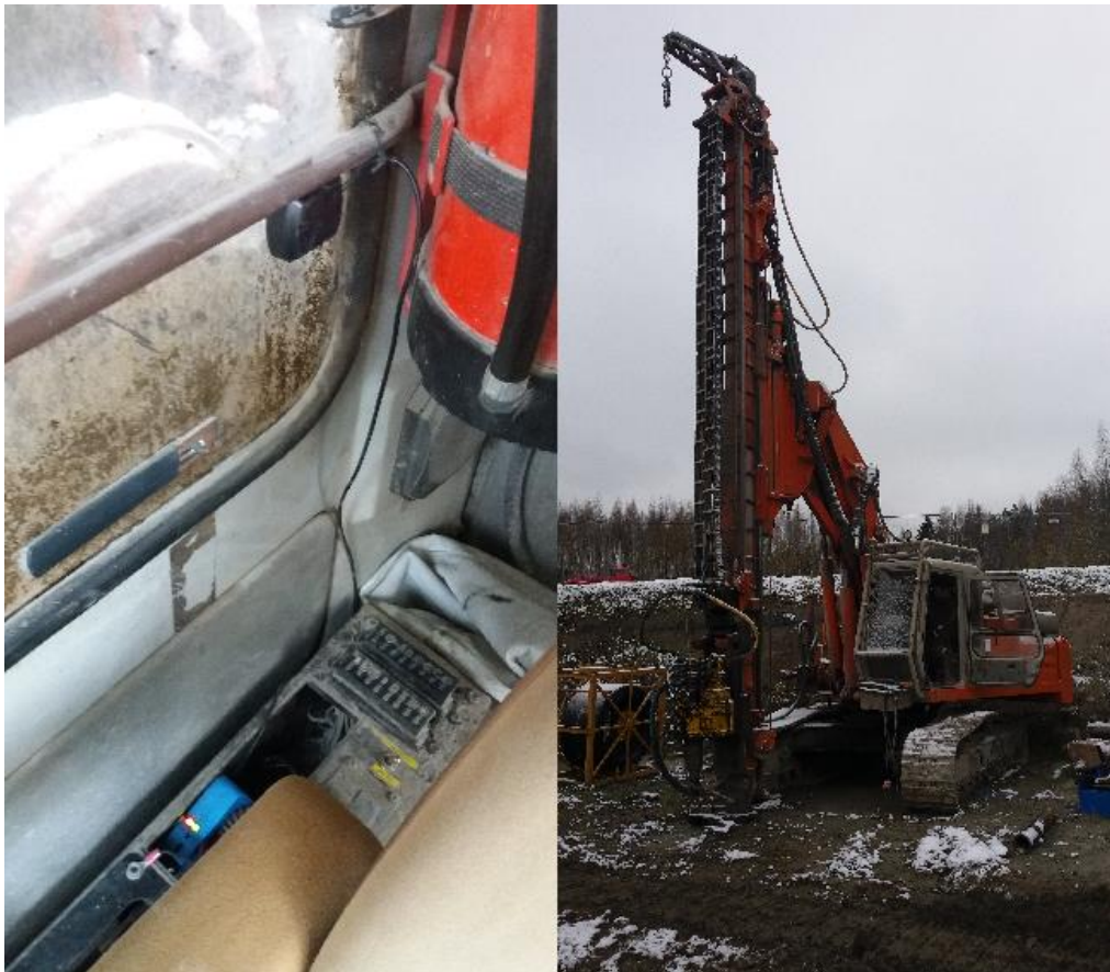
KUVA 9. ABI porakoneeseen laite asennettiin hyttiin josta antenni ottaa signaalin ikkunan läpi.
