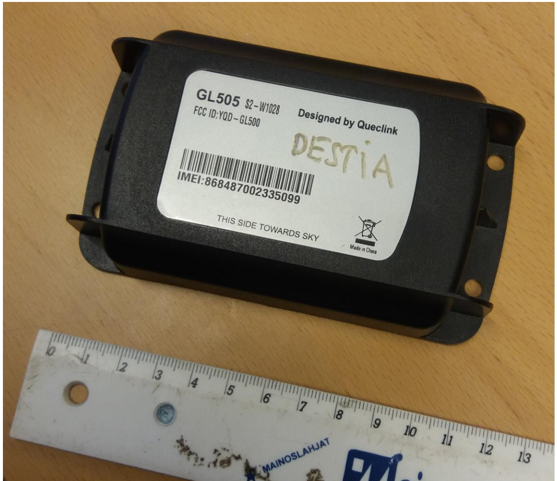
KUVA 5. Akkukäyttöinen Mapon seurantalaitte.
