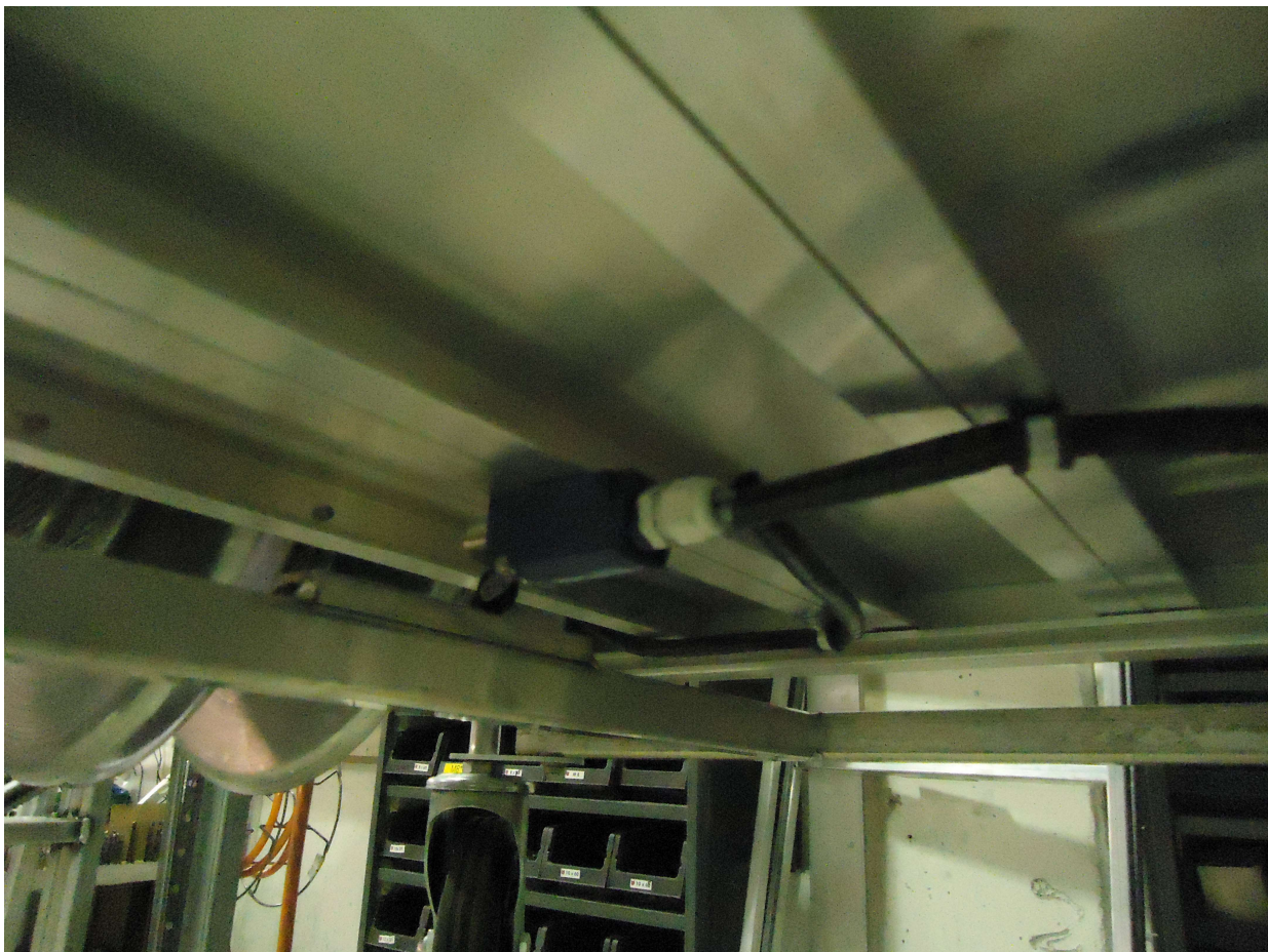
Kuva 13. Alarajakytkimen haaroitus ensimmäisellä rajakytkimellä.
