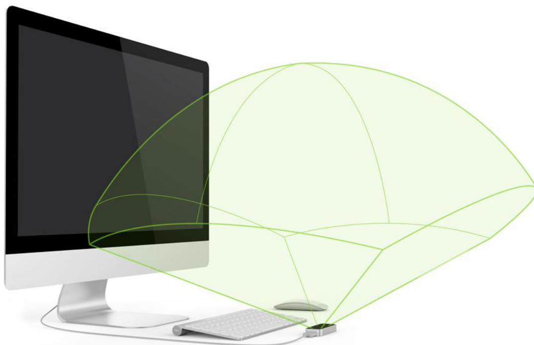
Kuvio 4: Leap Motion-ohjaimen toiminta-alue (Leap Motion 2017b).
