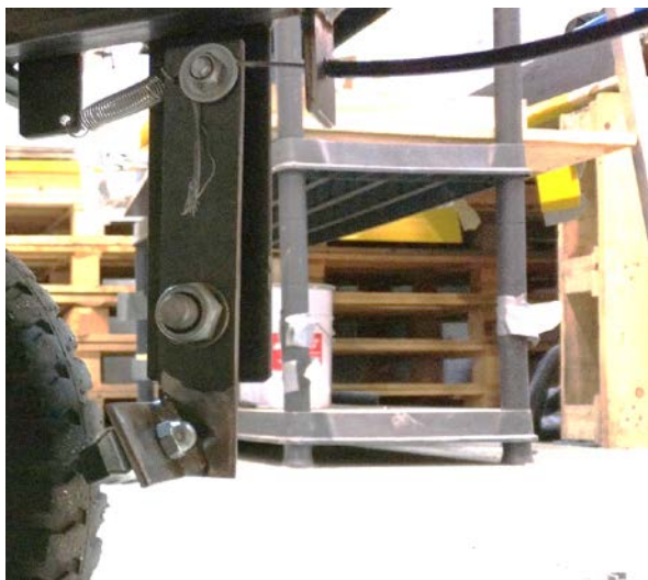
Kuvio 15. Jarrumekanismin toteutus prototyypissä 2
