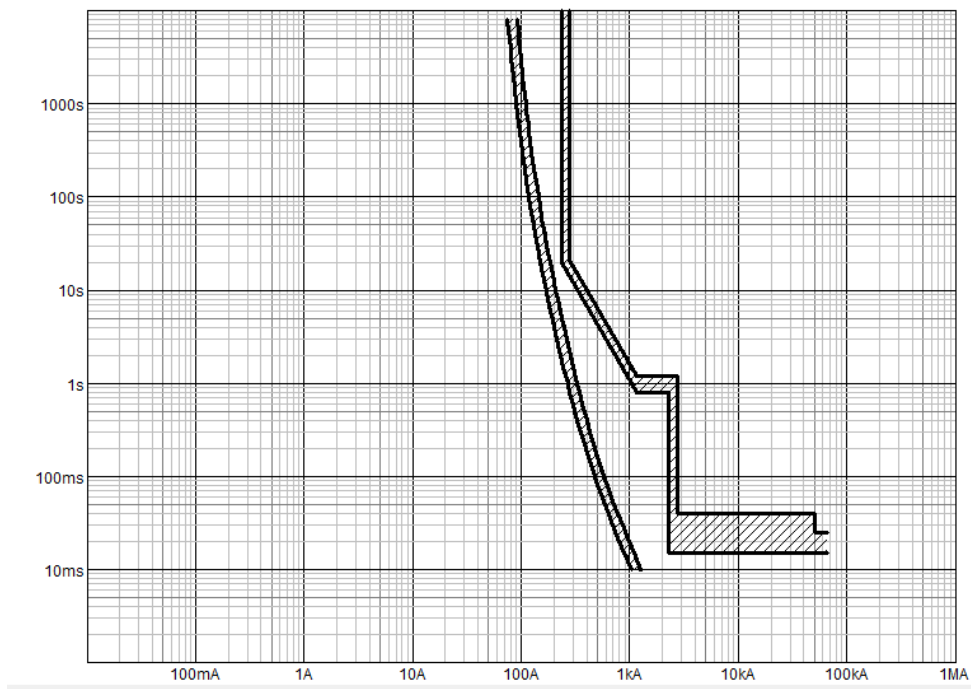
Kuvio 6. 63A-sulakkeen ja 250A-ilmakatkaisijan toimintakäyrät
