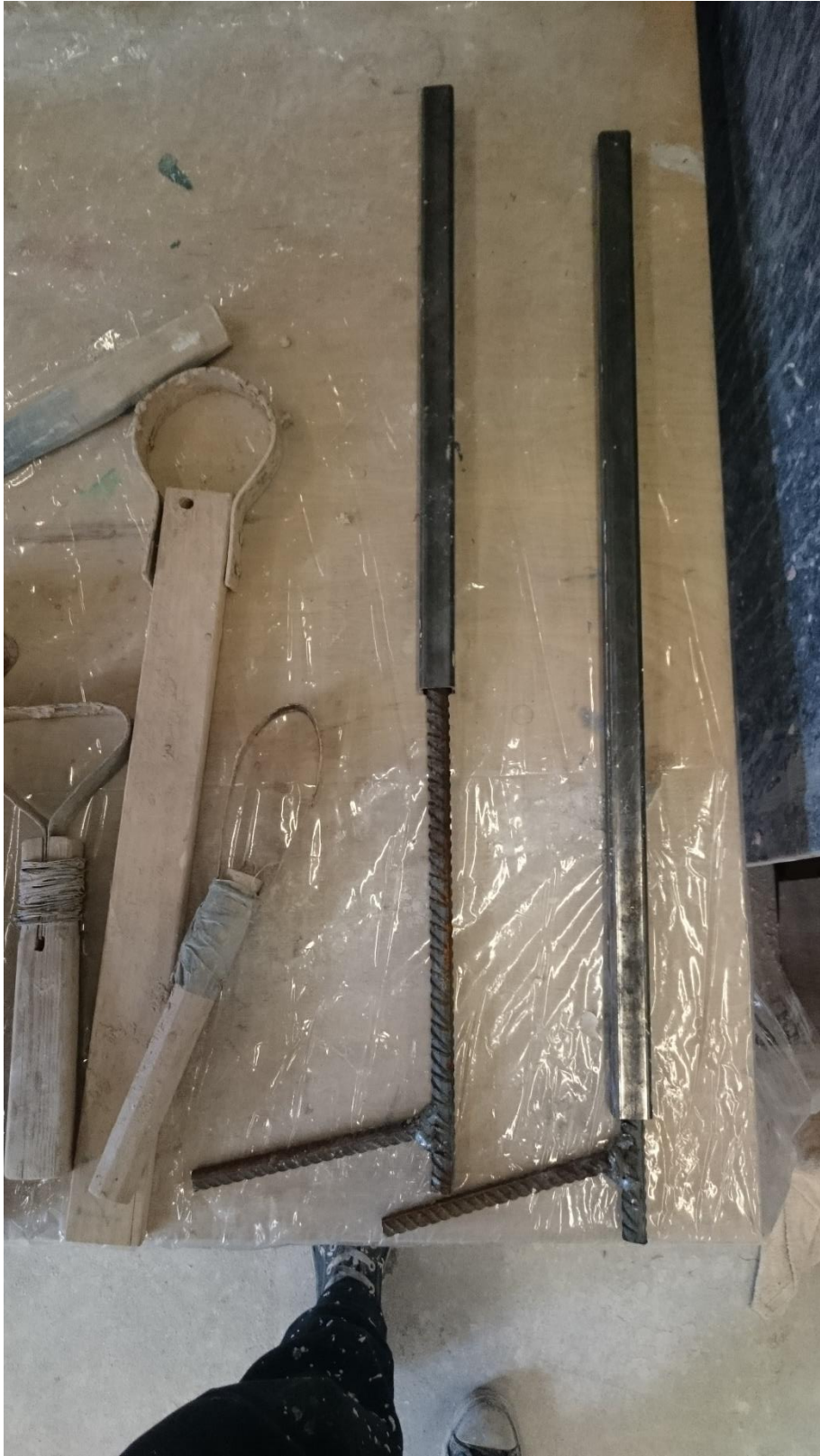
Jalustaan kiinnitettävät harjateräkset ja jalkoihin valettavat putket.
