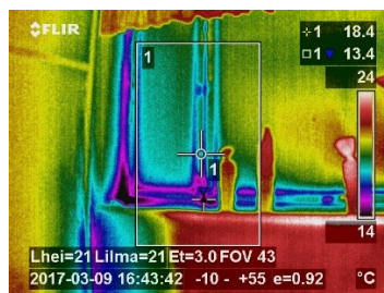
Kuva 15. Ilmavuoto luokkatilan ikkunassa sekä seinien liitoskohdassa.
