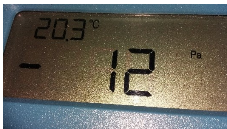
Kuva 24. 18.4.2017 kellarikerroksen paineellisuus ulkoilmaan verrattuna.
