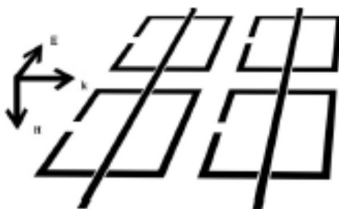
Kuva 31. Johderengas resonaattori ja ohuet johtimet. [65]
