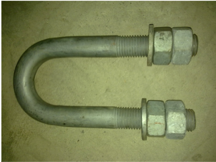
Kuva 4: U-pultti ja kiristysosat (Kuva: Mika Alisaari)
