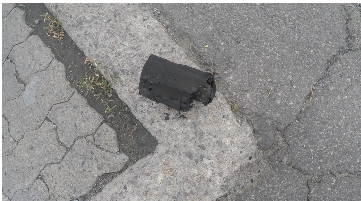
Kuva 43. LFP-akku kokeen jälkeen.
