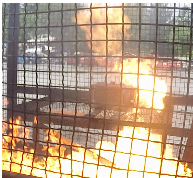
Kuva 48. HEV:n akku ensimmäisen purkauksen aikana.
