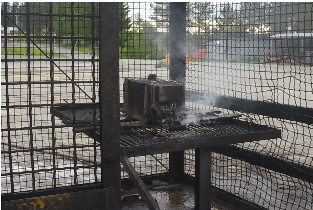
Kuva 49. HEV:n NCA-akku palon jälkeen.
