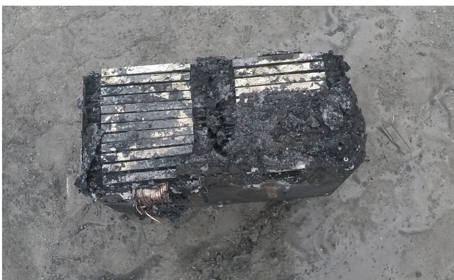
Kuva 46. NMC-akku kokeen jälkeen.
