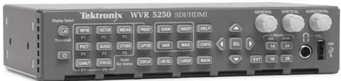
KUVA 12. Tektronix WVR 5250, rasterizer , joka liitetään erilliseen näyttöön (Tektronix 2013)
