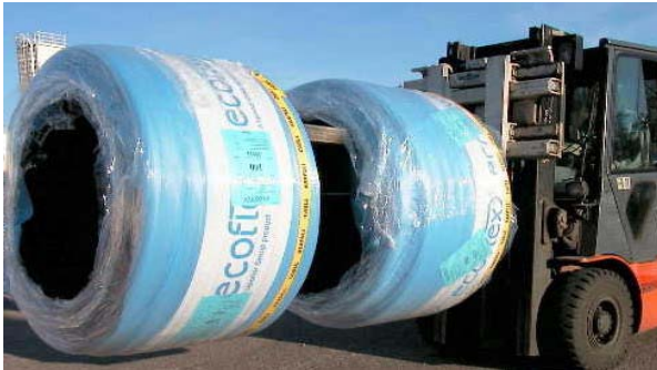
Kuva 14. Putkikela (Preinsulated / Eristetytputkistot Nastola 2009.)
