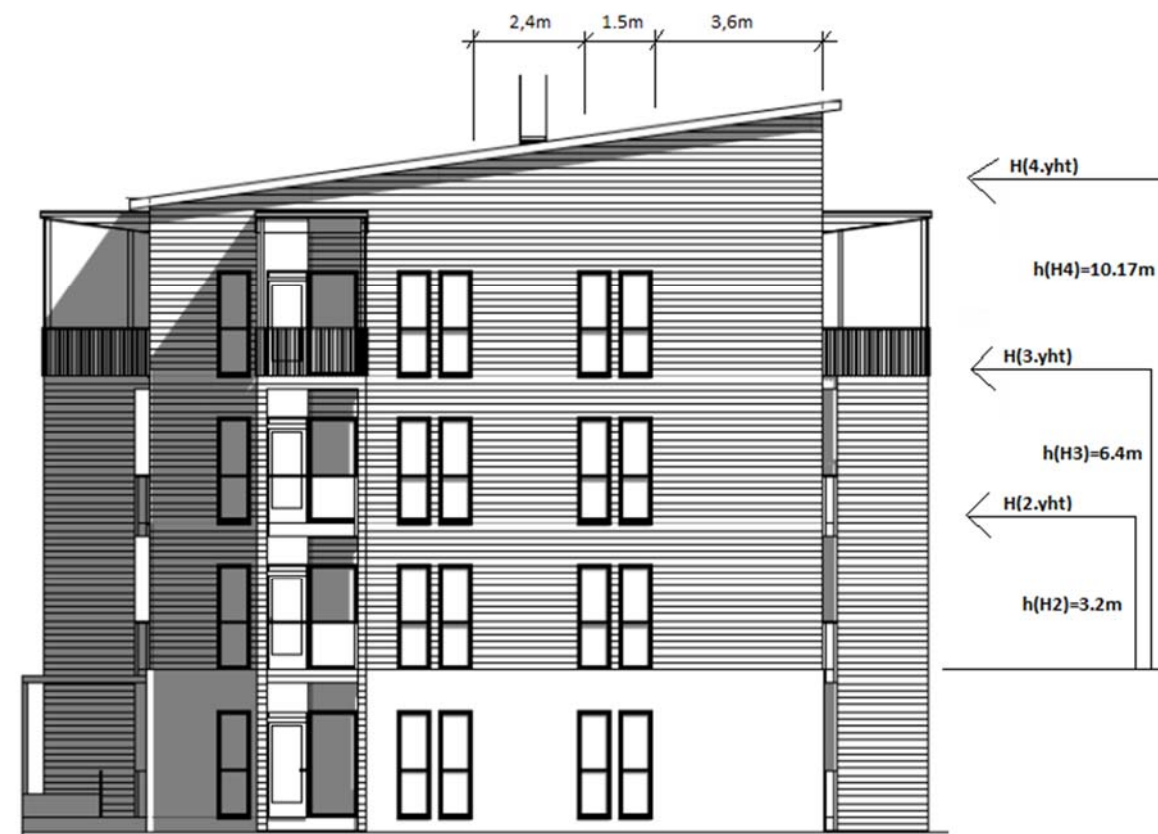
KUVA 29. Vaakakuormien kertyminen ja jäykistyslevyjien jako (Puuinfo.fi e, 5; muok. Mäklin 2017)
