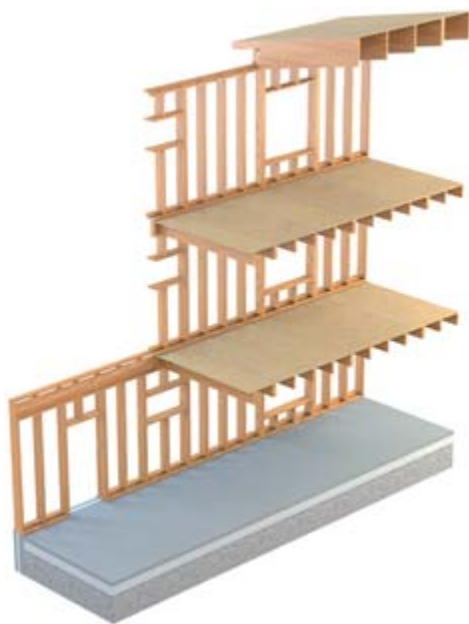
KUVA 9. Rankarunkoinen kantava seinä (Puuinfo.fi)
