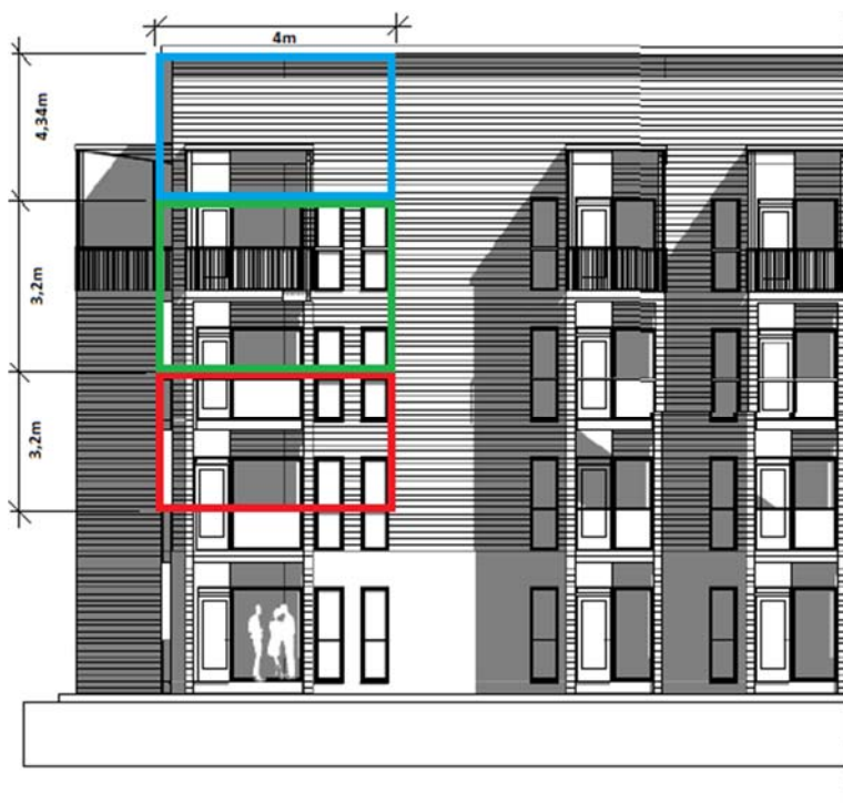
KUVA 27. Kerroskohtaisten tuulikuormien kuormitusalat (Puuinfo.fi e, 4; muok. Mäklin 2017)
