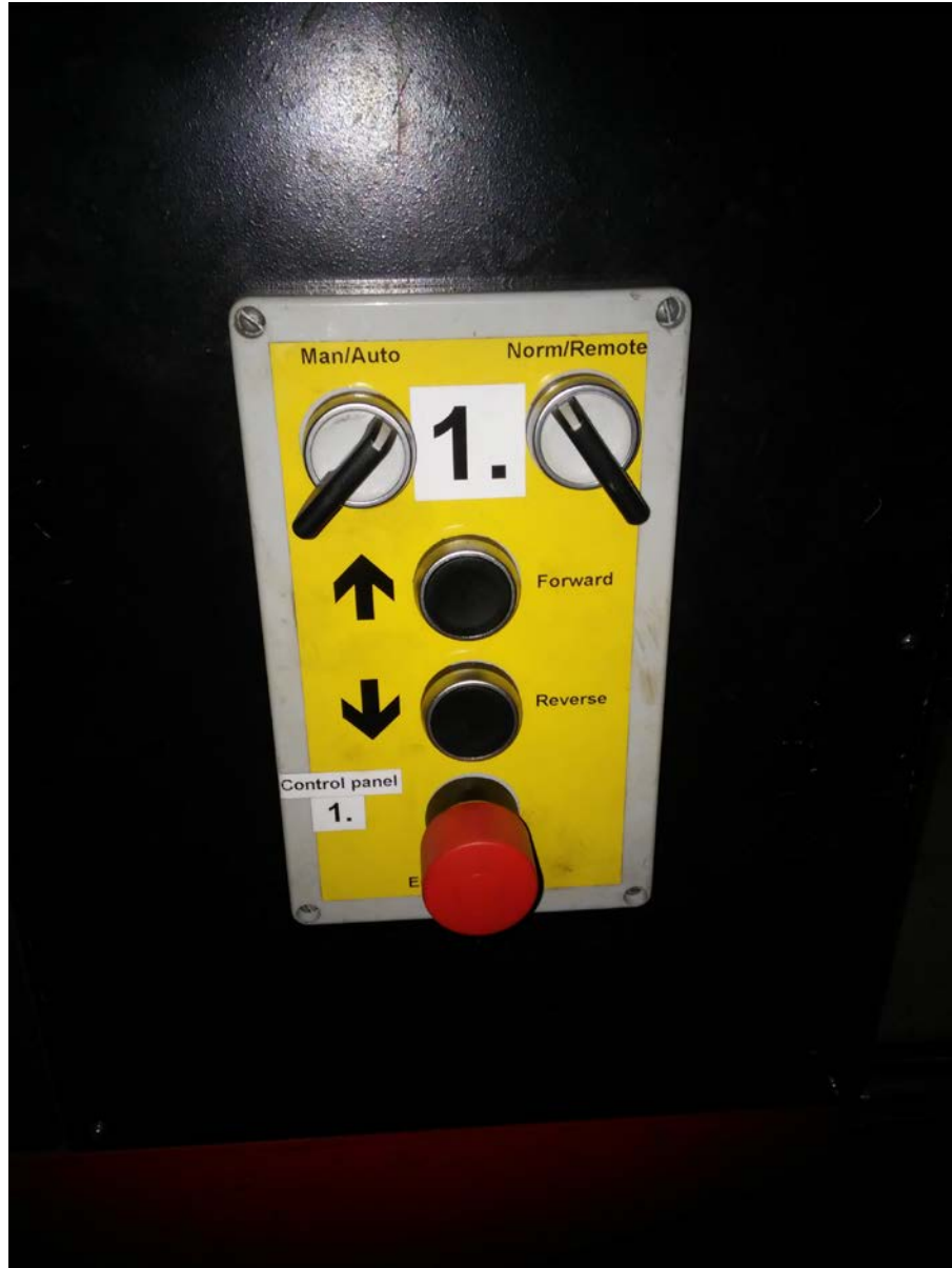
Kuva 29. Imuvaunun kaukoohjain kun ohjausta ei ole integroitu leikkauskoneen ohjauspaneeliin.
