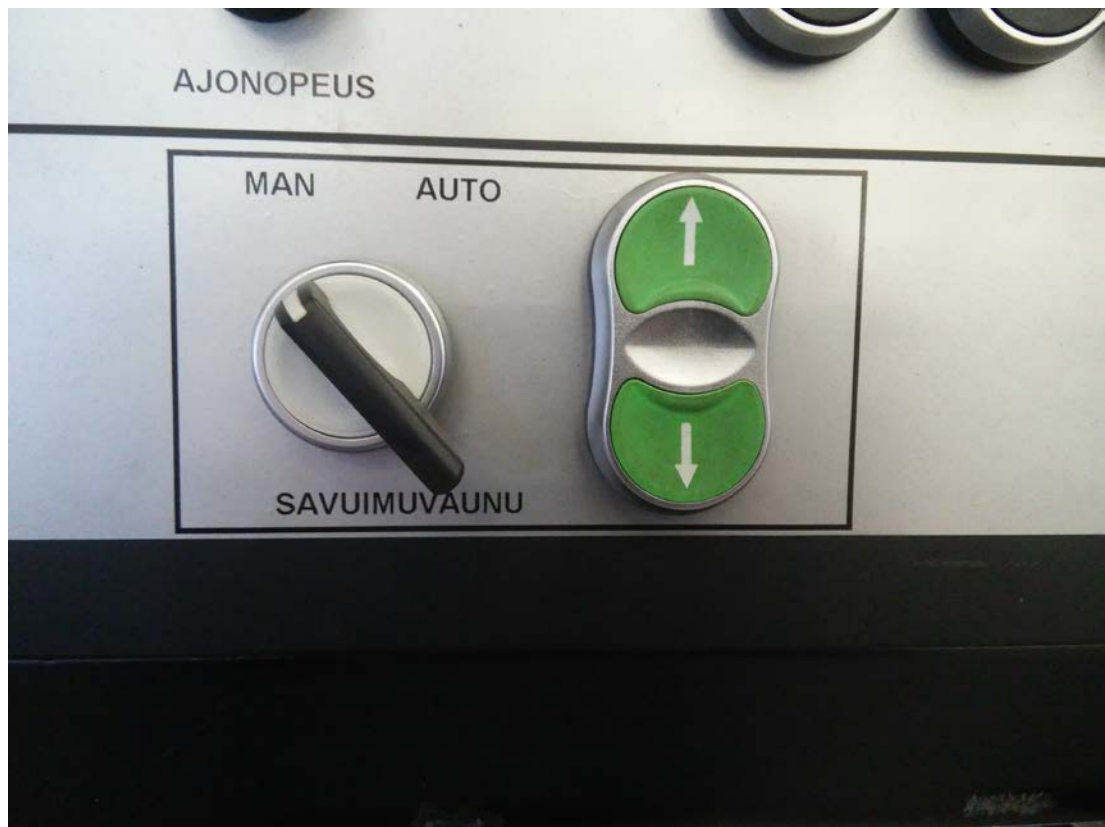
Kuva 28. Imuvaunun ohjausnäppäimet leikkauskoneen ohjauspaneelissa.
