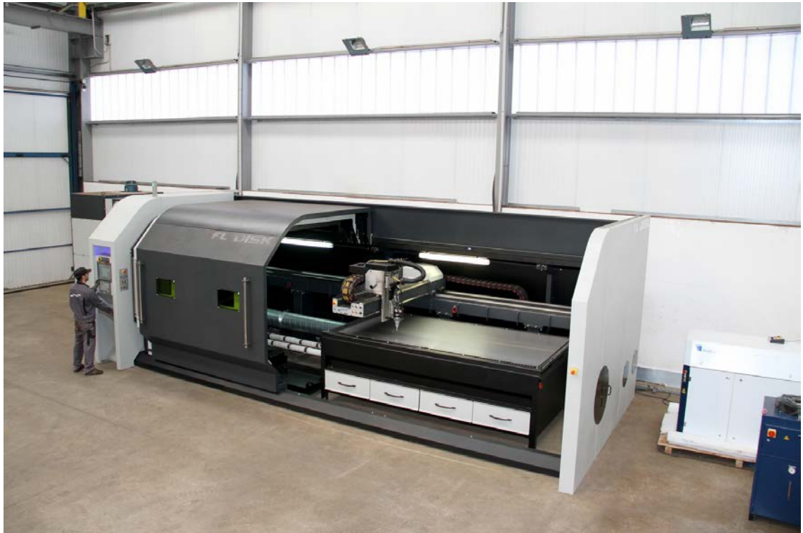
Kuva 9. Kuitulaserleikkaus kone(Tecoi www-sivut)
