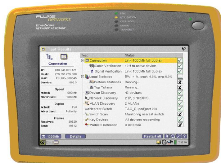
Kuva 2. Qt:llä toteutettu käyttöliittymä Fluken EtherScope-mittalaitteeseen ( http://www.ferret.com.au/odin/images/165750/New-version-Fluke-Etherscope-from-TR-Corporation-165750.jpg )
