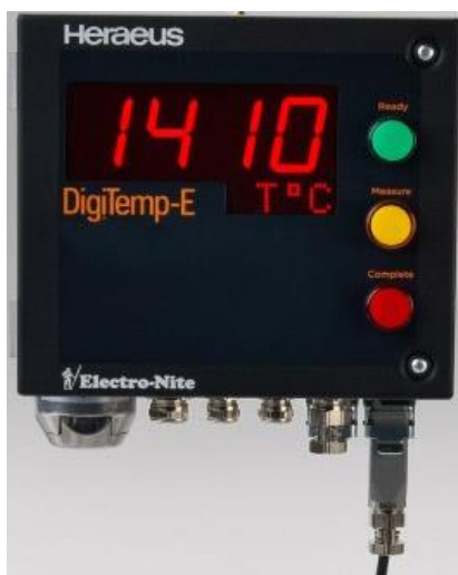
Kuva 2. Heraeus DigiTemp-E lämpötilamittari ( Heraeuksen www-sivut 2017 )
