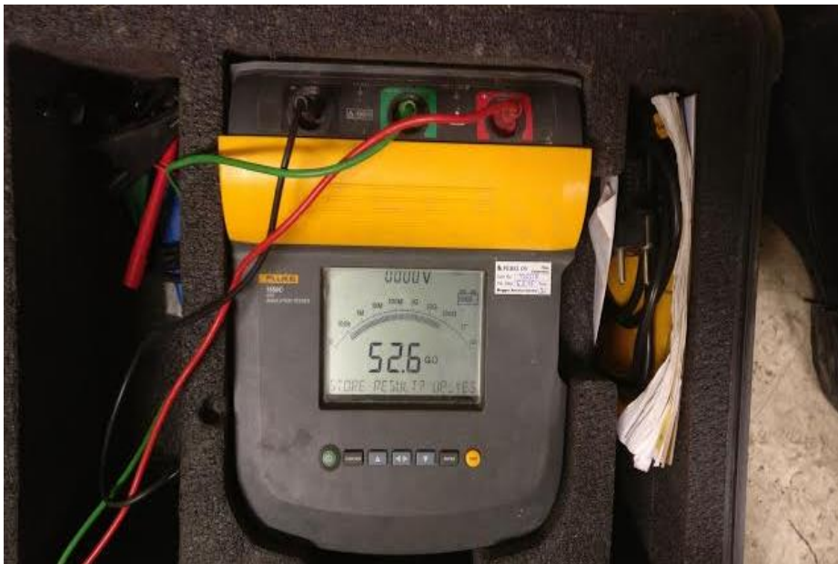
Kuva 12. Eristysvastusmittari Fluke 1550C (Veli-Pekka Lempiö)
