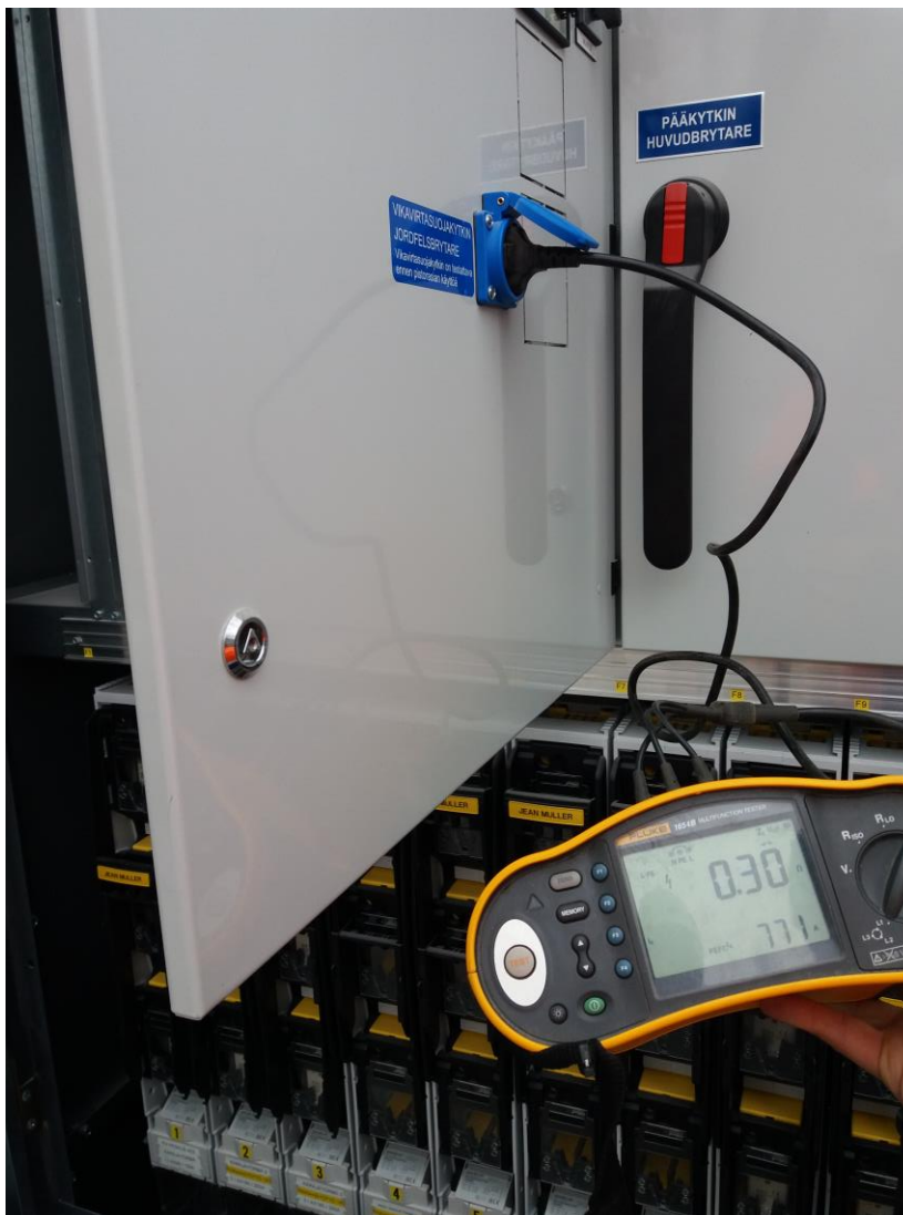
Kuva 18. Silmukkaimpedanssin mittaus 1-vaihepistorasiasta (Veli-Pekka Lempiö)
