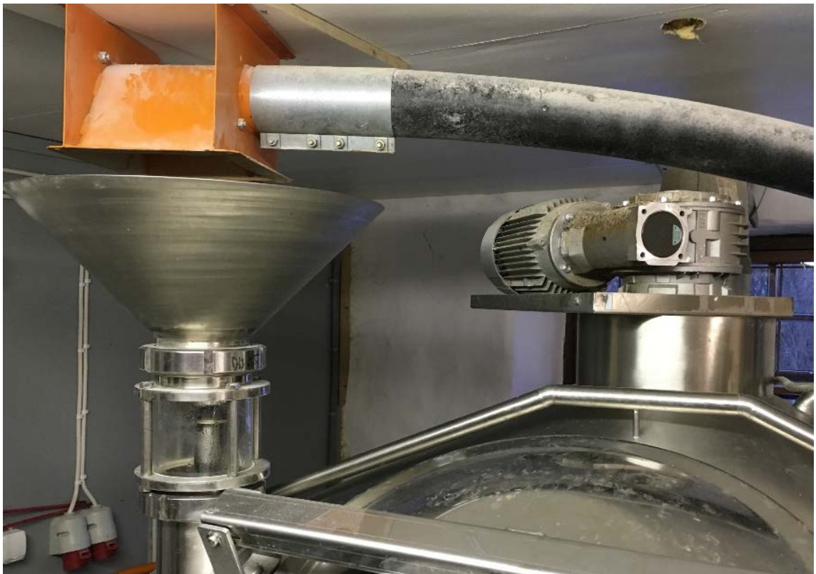
Kuva 3. Suppilolla varustettu esimäskäin keittokattilan päällä ja siihen tuleva ruuvilinja.
