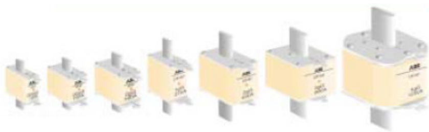
Kuva 3.3 kahvasulakkeita kokojärjestyksessä 00, 0, 1, 2, 3, 4 ja 4a
