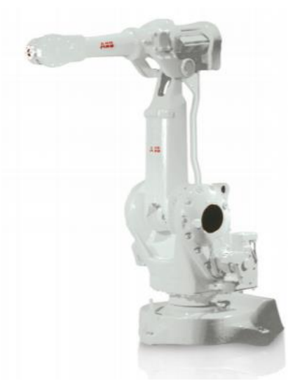
KUVA 24. ABB:n IRB 2400-16 robotti (ABB, linkit tuotteet ja palvelut -> Robotit -> IRB 2400)
