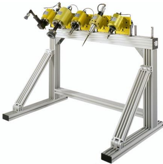
KUVA 12. Työkaluhylly (Amtru, linkit Robot applications -> Tools -> Accessories)
