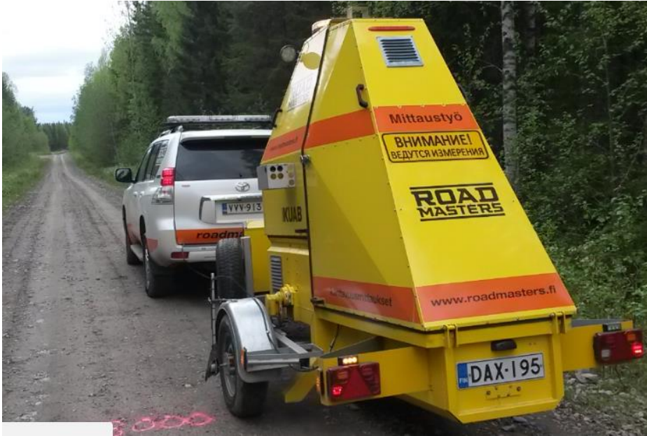
Kuva 15. KUAB FWD 50 pudotuspainolaite. (16.)
