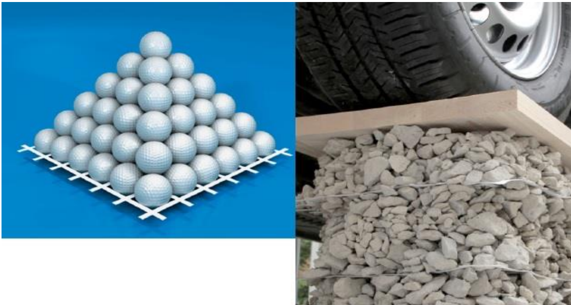
KUVA 3. Geoverkkojen toimintaperuste (3, s. 4.) ja (4, s. 3.)
