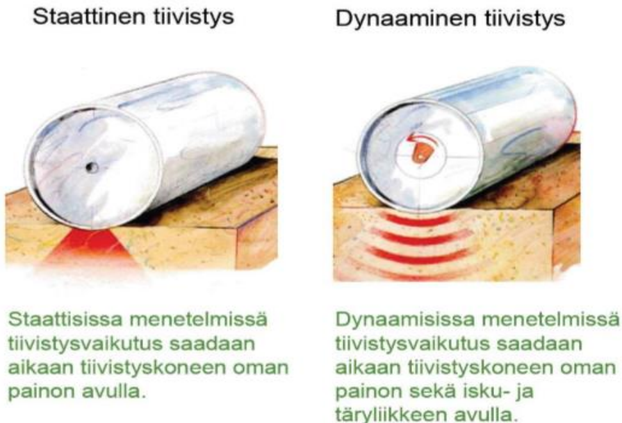
KUVA 10. Staattinen ja dynaaminen tiivistys. (15, s.103)
