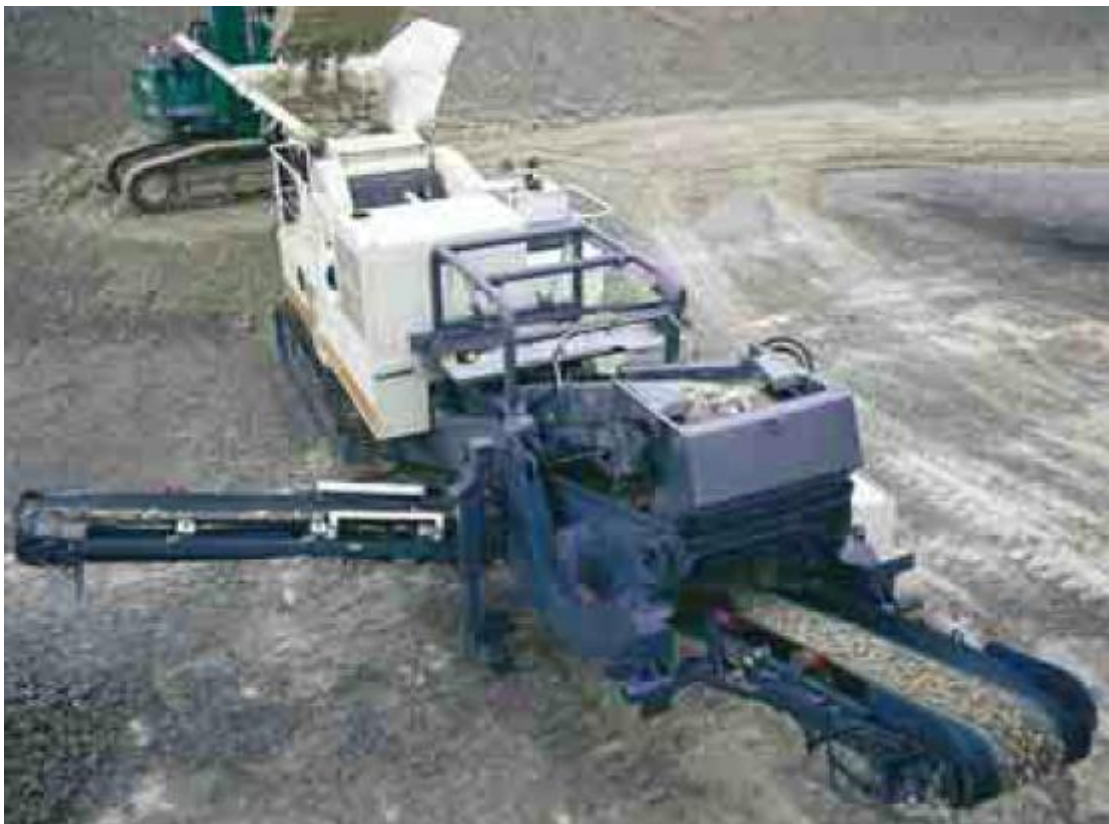
Kuvio 5: LT96S tela-alustainen murskausyksikkö kaksisuuntaisella seulalla (Metso Minerals (Tampere) Oy, Intranet sivut).
