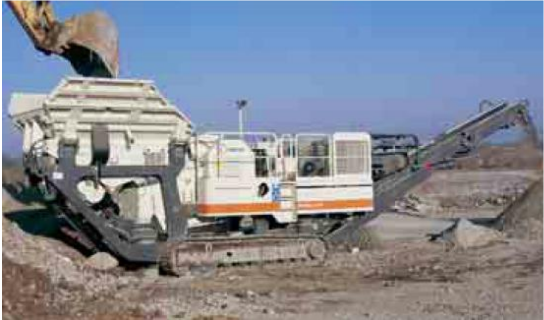
Kuvio 4: LT96 tela-alustainen murskausyksikkö (Metso Minerals (Tampere) Oy, Intranet sivut).
