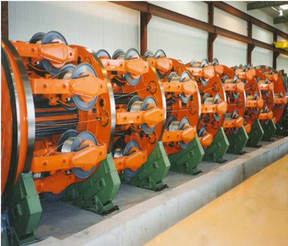
KUVA 5. Queinsin valmistama armeerauskone (8)
