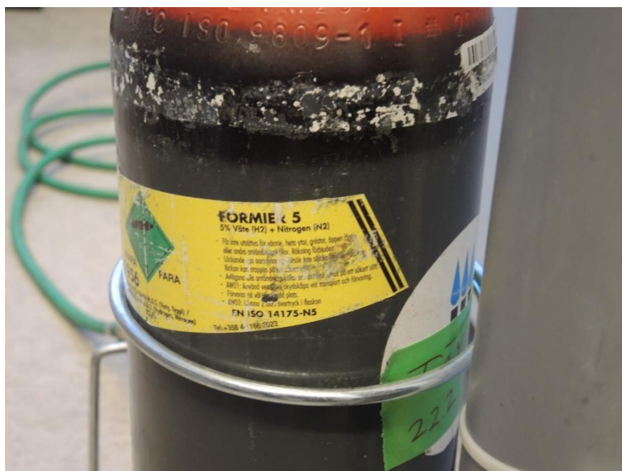
Kuva 13. Merkkiainekokeessa käytetty kaasu typpi-vety-seos (Passi 2017-03-16)
