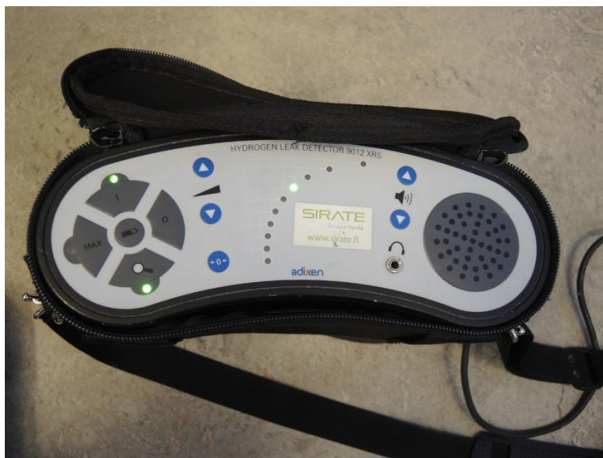
Kuva 12. Merkkiainekoe vuodonhakulaite, Adixen 9012 XRS (Passi 2017-03-16)
