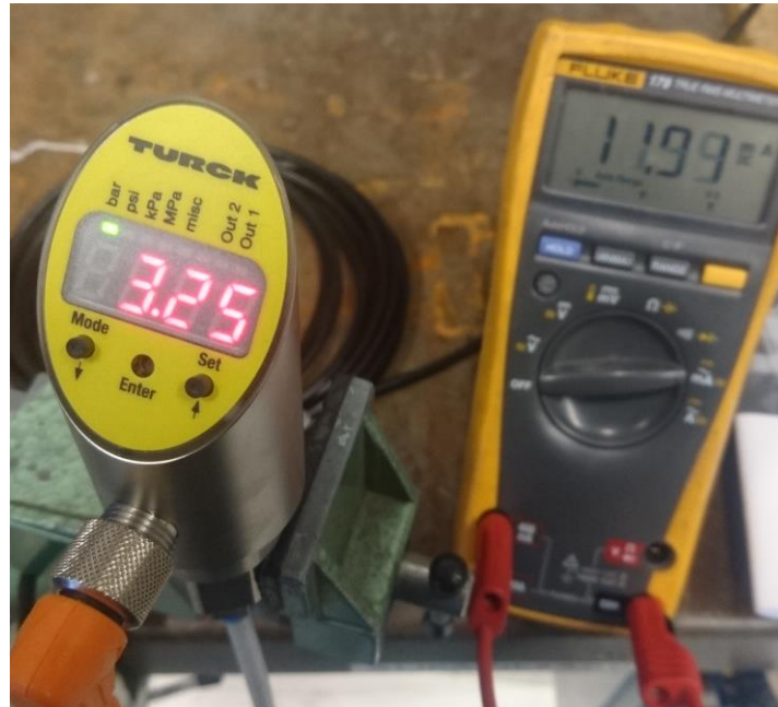
Kuva 12 Painelähettimen koeviritys 0-6,5 bar
