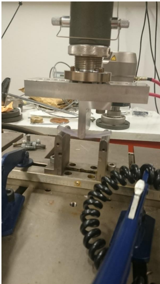
KUVA 21. Instron 8874-aineenkoetuslaitteeseen asennettu kolmipistetaivutus järjestelmä.
