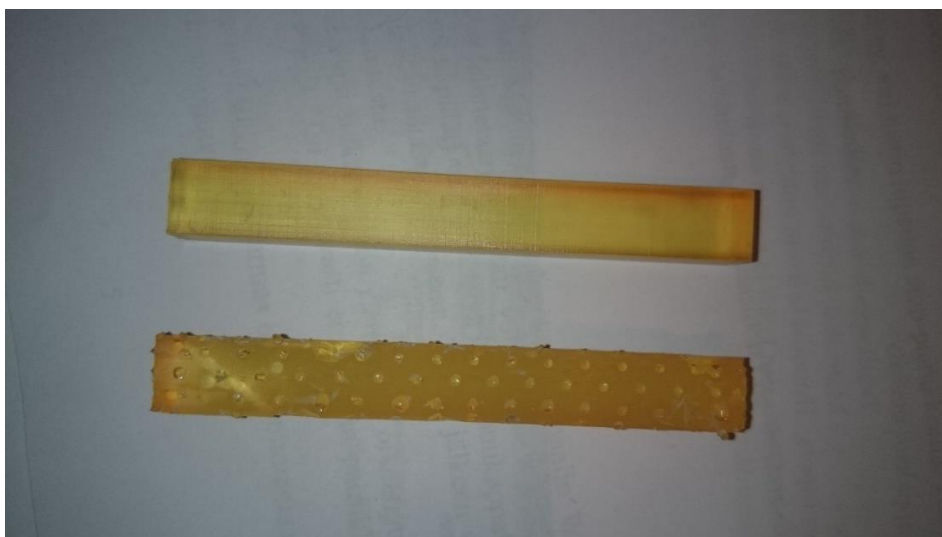
KUVA 19. Kuvassa ylempänä 90° kulmassa tulostettu iskusauva ja alempana 0° kulmassa. Kolot, johtuivat tukimateriaalin huonosta irrottamisesta.
