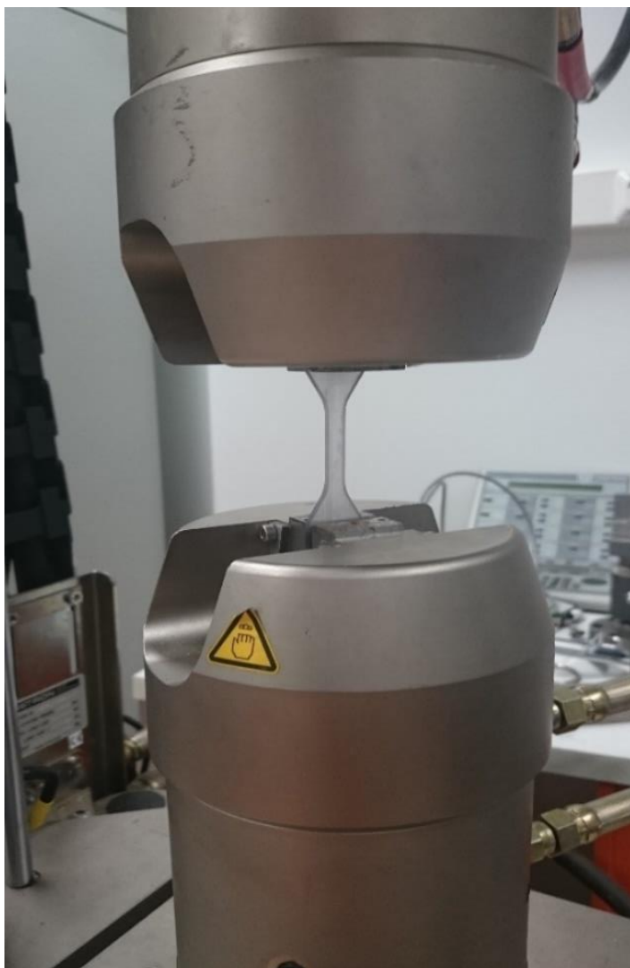
KUVA 20. Vetosauva kiinnitettynä Instron 8874-aineenkoetuslaitteeseen.
