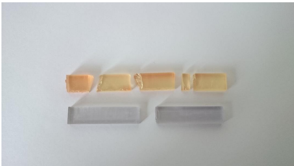
KUVA 24. Taivutussauvojen murtumat. Ylempänä Dental SG:sta valmistettu taivutussauva ja alempana Varseo Wax:sta valmistettu.
