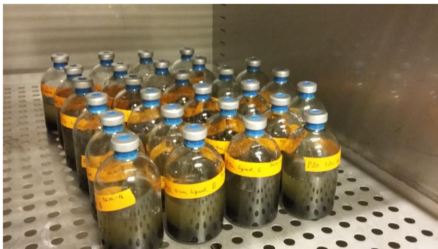
KUVA 1. Nollakuitusedimentin panospullot lämpökaapissa
