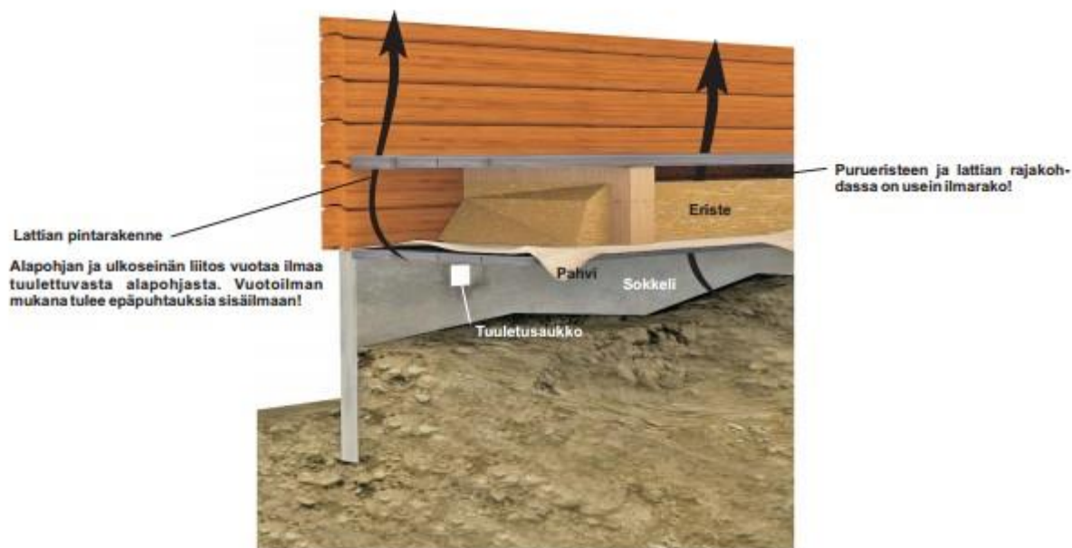
KUVA 25. Tuulettuva alapohjarakenne (Hometalkoot 2012)
