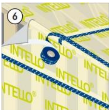
KUVA 24. Höyrynsulun limitys ja teippaus ulkoseinän ja yläpohjan liitoksessa (Tiivistalo.fi)
