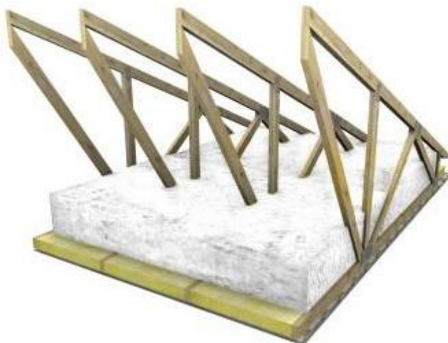
KUVA 22. Kuvassa nykyaikainen, pientaloissa käytetty, ristikkorakenteinen yläpohja (Isover.fi)
