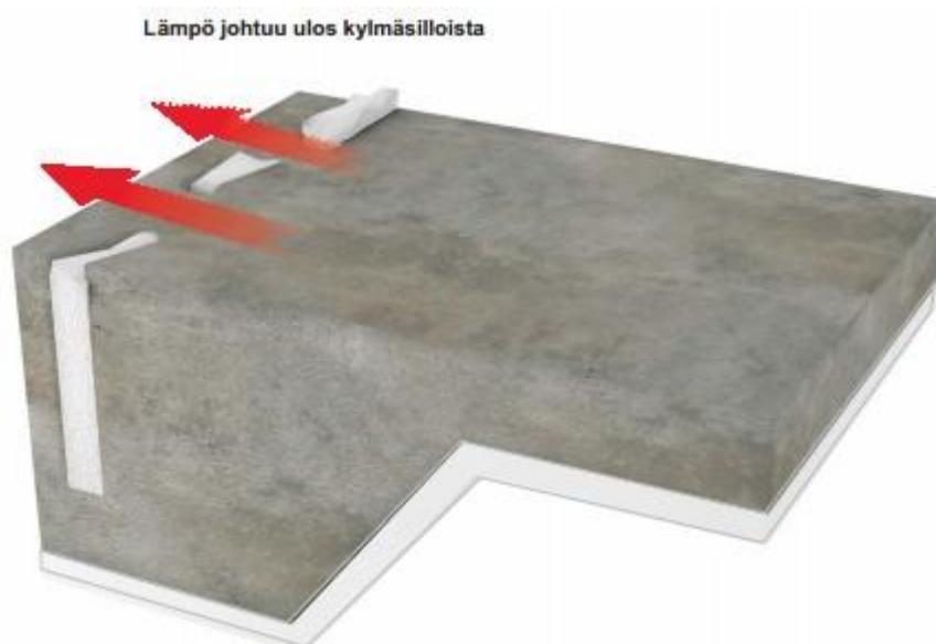
KUVA 15. Eristyksen rikkoontuminen valuvaiheessa aiheuttaa kylmäsiltoja rakenteeseen (Hometalkoot 2012)
