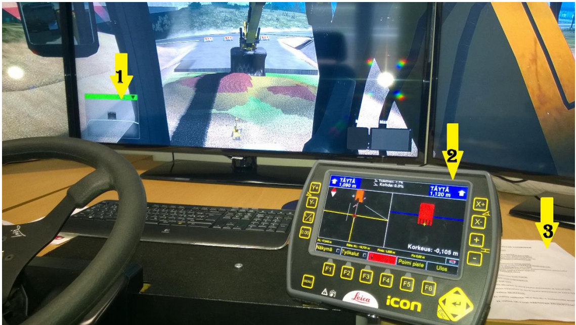
Kuvio 16. Leican koneohjausyksikkö yhdistettynä simulaattoriin
