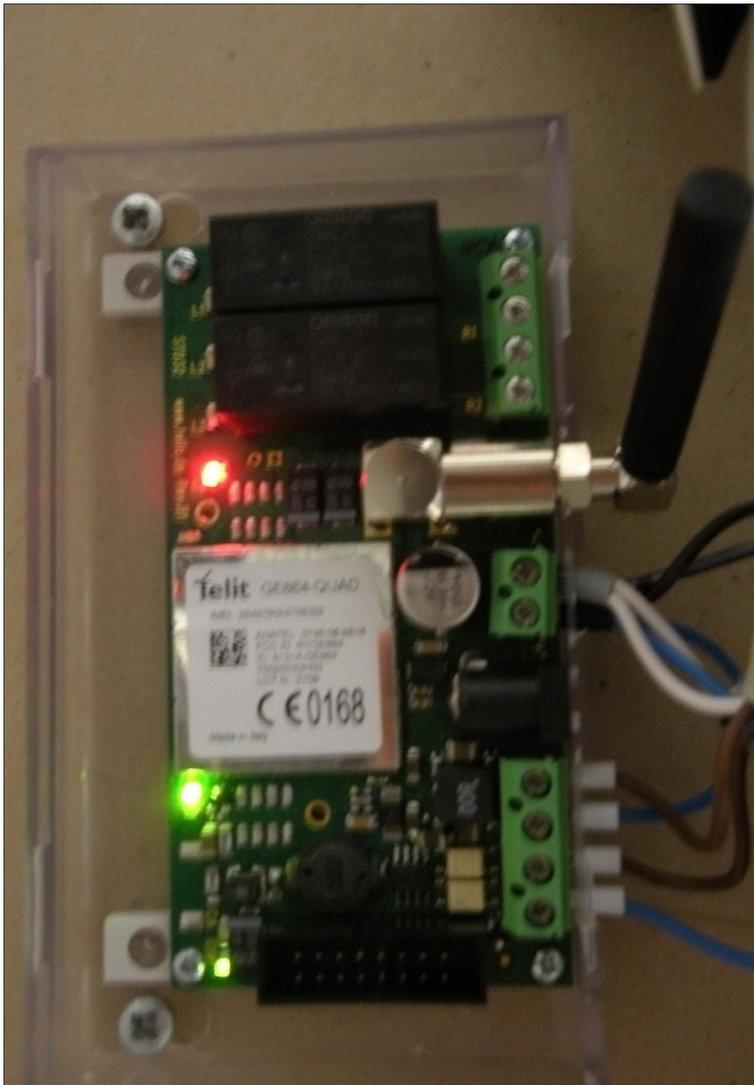
LIITE 3. STD32-GSM-modeemi asennettuna
