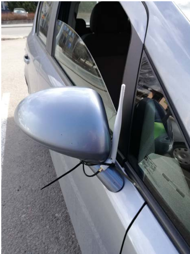
Kuva 14. Henkilöautoon kiinnitetyn päätelaitteen antennin sijoittelu.
