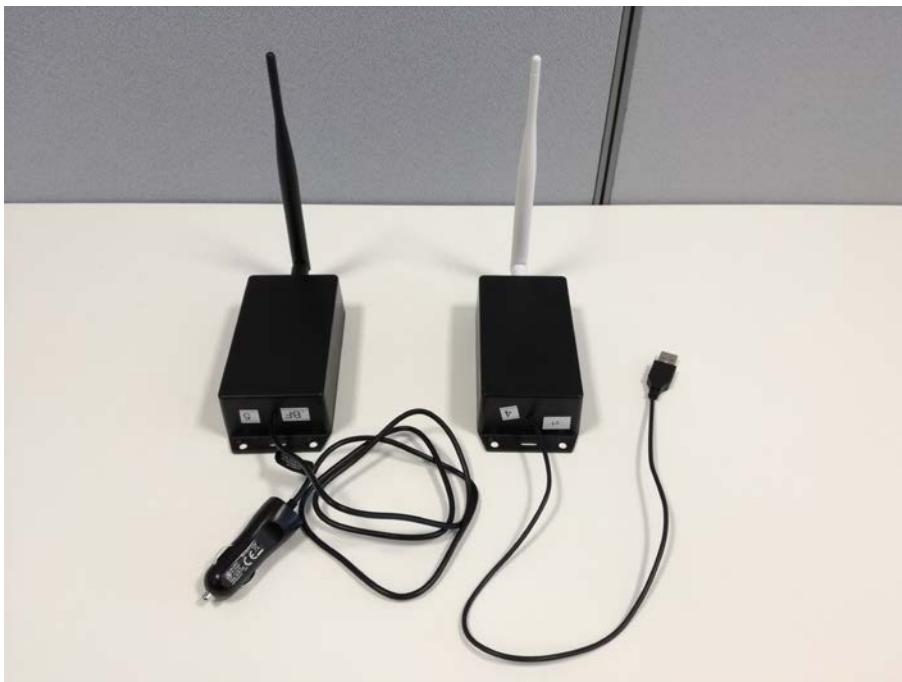
KUVA 8. Vasemmalla ajoneuvoon tarkoitettu testipätelaite ja oikealla USB-virralla toimivaksi muunnettu testipätelaite.
