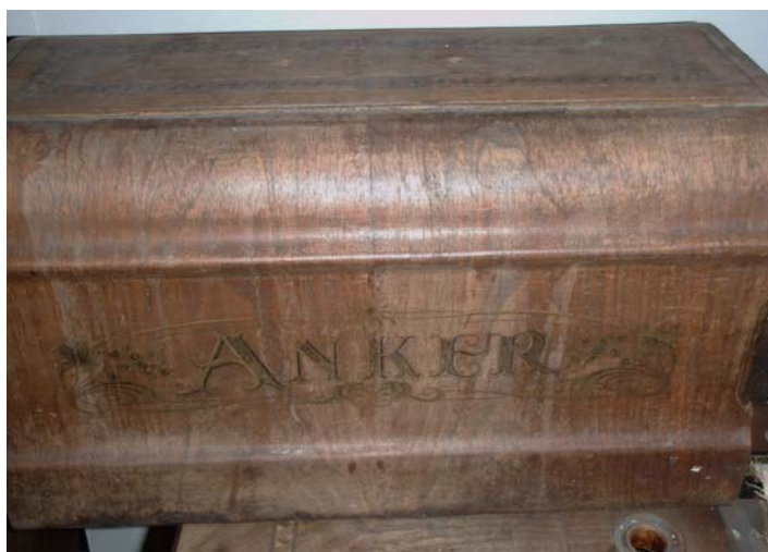
Kuva 18. Suojakopan vaurioitunut lakkapinta (Nivell 2010)
