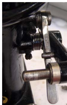
Kuva 82. Puolauslaitteisto puhdistuksen jälkeen (Nivell 2010)
