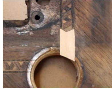
Kuva 38. Paikattu sokkoviilu (Nivell 2010)
