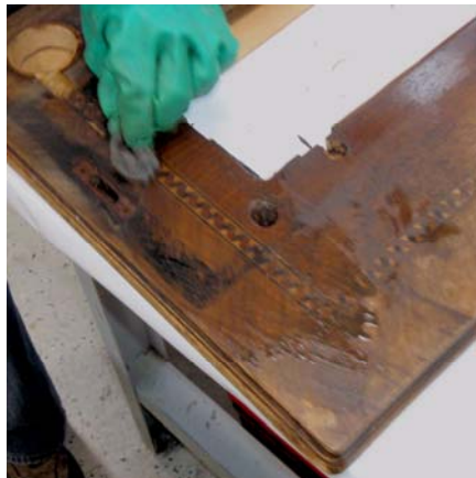
Kuva 35. Lakan poisto ja puhdistus (Nivell 2010)
