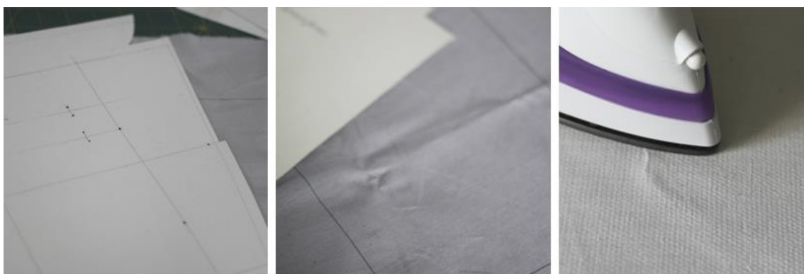
Kuva 43. Vuorikappaleiden leikkaus ja vuorin tukivuorien kiinnitys.
