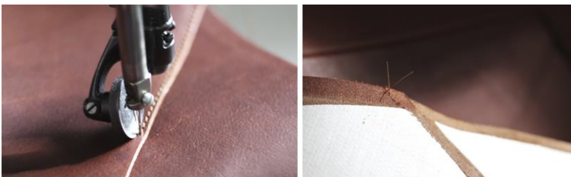
Kuva 35. Kappaleiden yhteen ompelua. Langanpäät viimeistelin polttamalla.
