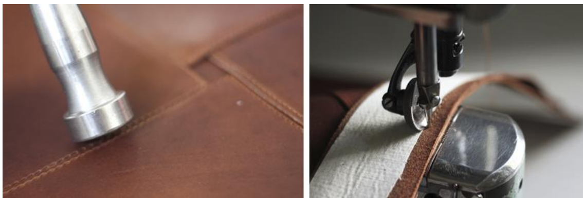
Kuva 37. Naputtelin viikausvasaralla ompeleita, jotta ne painuvat nahkaan ja näyttävät siistimmiltä. Umpisauman ompelua.
