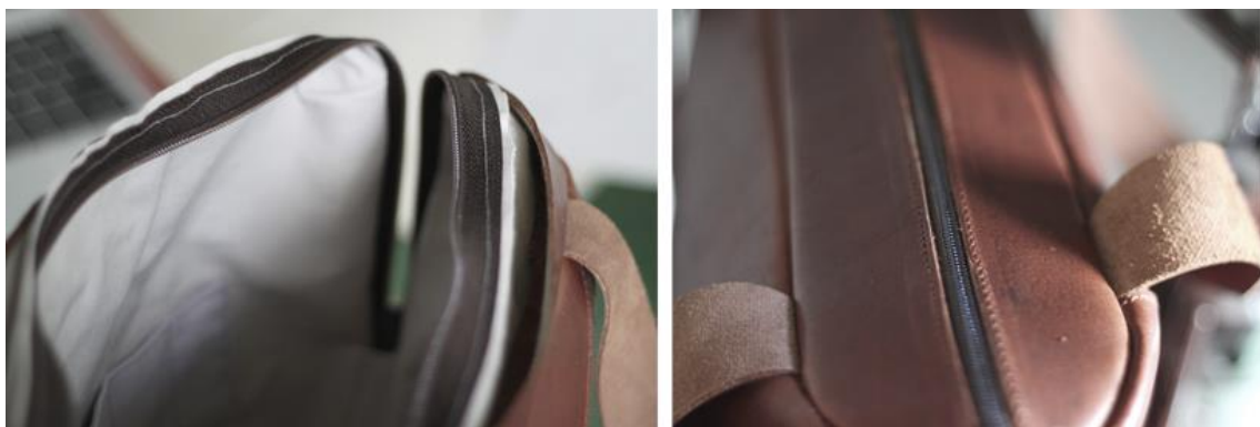
Kuva 46. Laukun vetoketju on ensin ommeltu kiinni vuoriin. Vuori ja vetoketju kiinnittyvät yhdellä tikkirivillä laukkuun.
