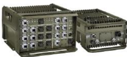
Kuva 4. Taktinen Reititin sekä Radiopääte yksi (Radio head one)
