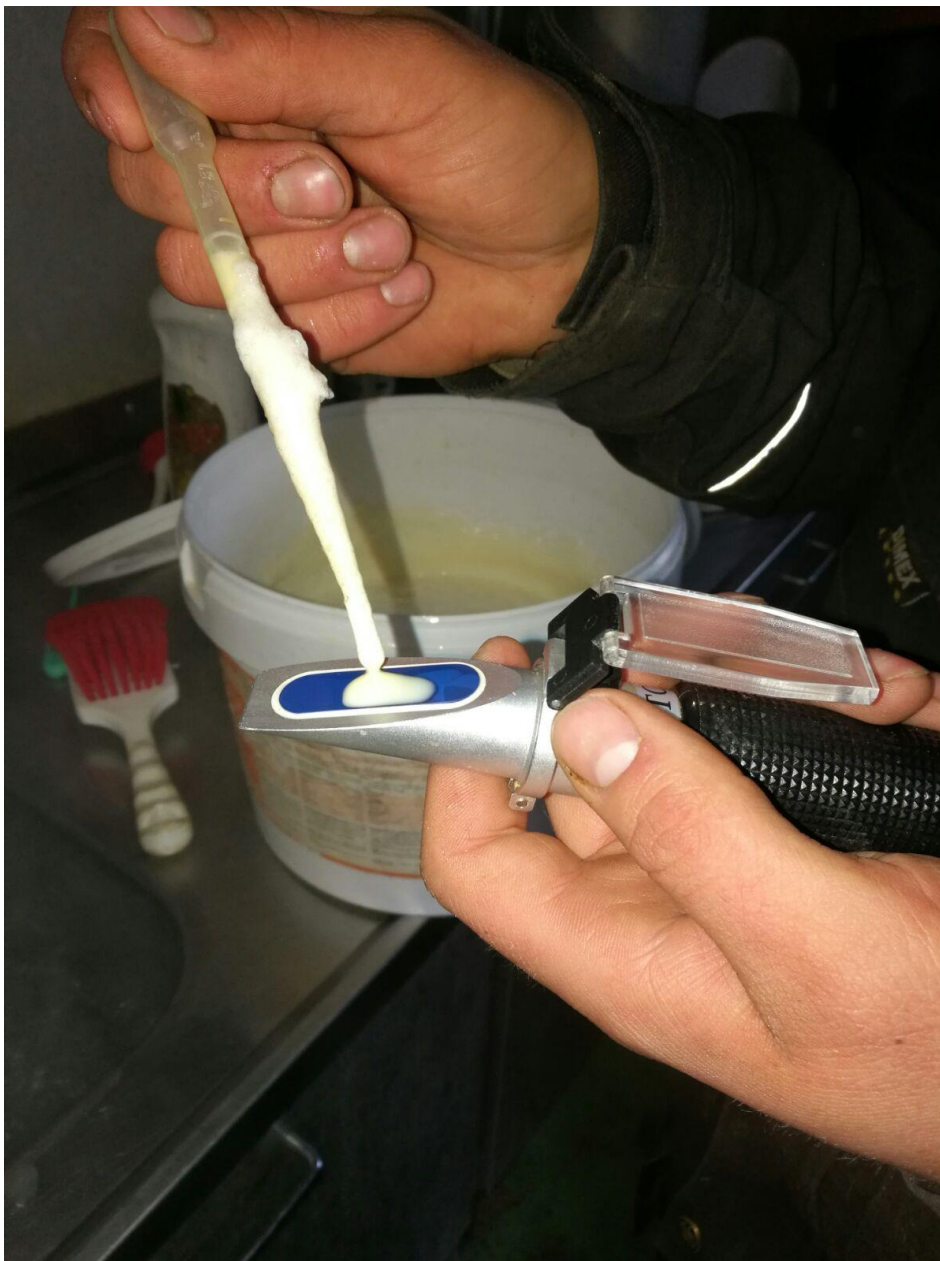
Kuva 1. Vasta-ainepitoisuuden mittaaminen refraktometrin avulla.
