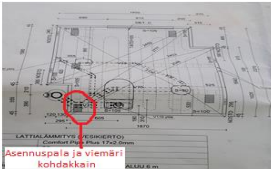
Kuva 17. Piirustuksessa asennuspala osuu juuri viemärin kohdalle
