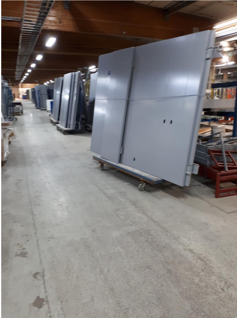
Kuva 7. Kasetit on liitetty yhteen seiniksi ja menossa laatoitukseen.
