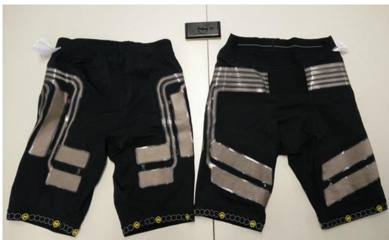
Figur 4. Smartshortsens ytelektroder (aviga sida) och trådlösa sändaren. Fotograf Anette Forsström 2017.
