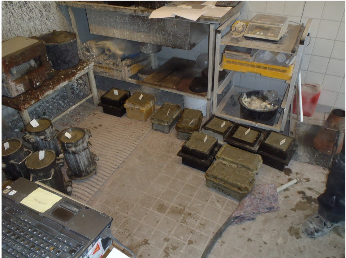
Kuva 5. erilaisia valettuja koekappaleita muoteissaan laboratoriossa.
