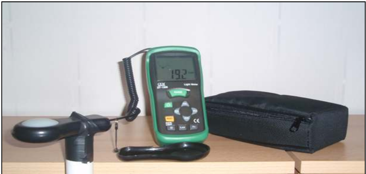
Kuva 8.1. Mittauksissa käytetty valaistusvoimakkuusmittari DT-1308.
